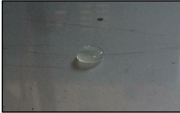
Slika 29. Tableta otisnuta tehnikom direktnog istiskivanja iz gelova fotopolimeriziranjem pomoću UV zračenja.
