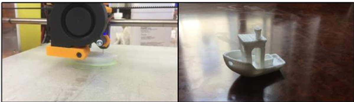
Slika 8. 3D-printer prilikom tiskanja FDM tehnikom lijevo te gotov objekt desno.
