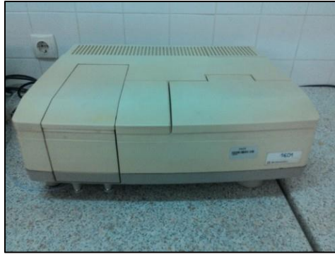
Slika 12. UV/Vis spektrofotometar Shimadzu UV-1601
