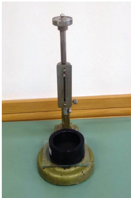
Slika 17: Vicat-ov aparat za određivanje vremena vezanja
