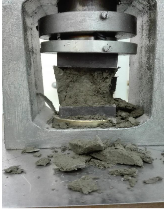
Slika 22: Cementna prizma v/c faktora 0,2
