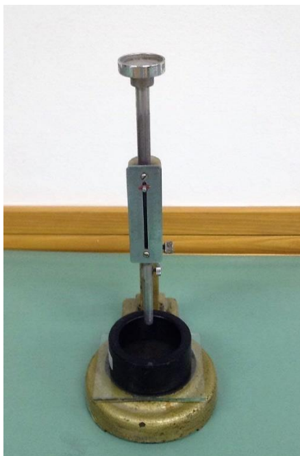
Slika 15: Vicat- ov aparat za određivanje standardne konzistencije
