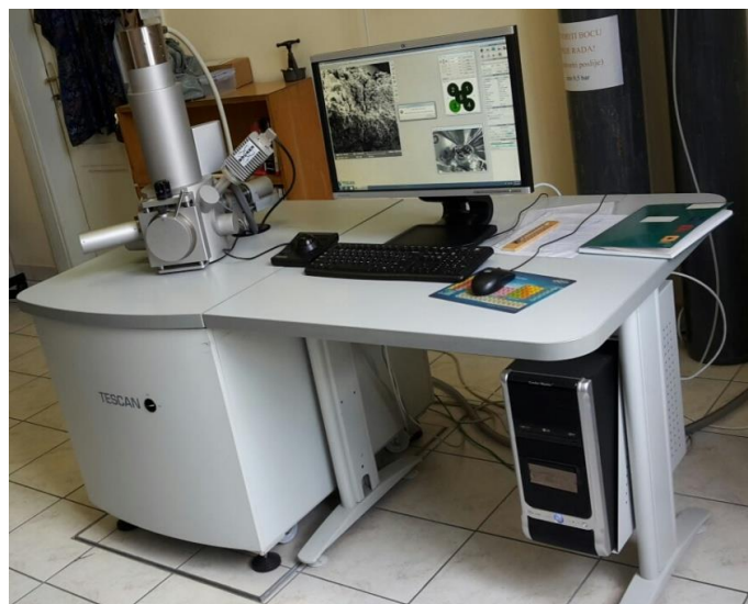
Slika 13. Pretražni elektronski mikroskop Vega 3 ( Tescan, Češka )
