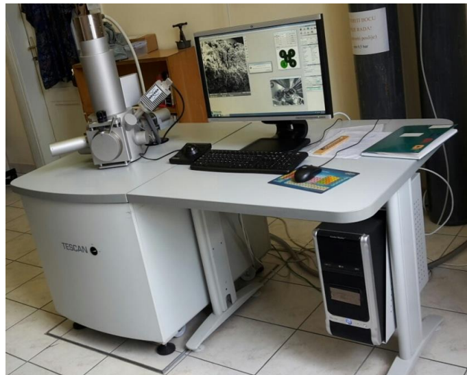
Slika 13. Pretražni elektronski mikroskop Vega 3 ( Tescan, Češka )
