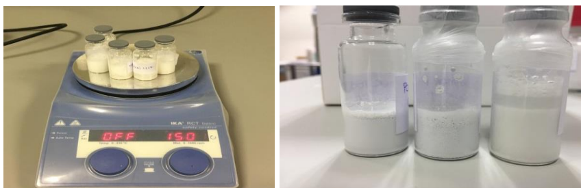
Slika 9. Magnetska mješalice i dobiveni uzorci vodenih suspenzija dronedarona i stabilizatora
