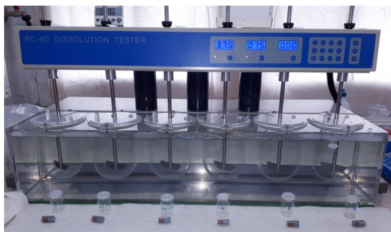
Slika 17. Uređaj za ispitivanje brzine oslobađanja djelatne tvari RC-6D ( Zhengzhou Nanbei, Kina )
