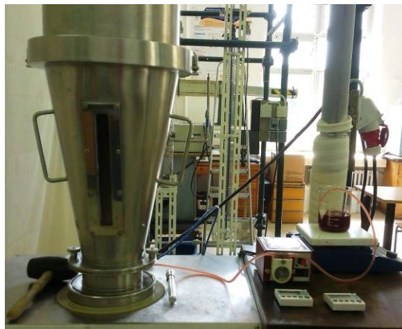
Slika 12. UniGlatt uređaj za oblaganje u fluidiziranom sloju ( Glatt GmbH, Njemačka )
