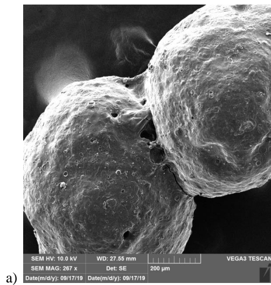
Slika 26. SEM-mikrografija: impregnirane pelete nakon oblaganja (60c) pri uvećanju: a) 200x; b) 500x
