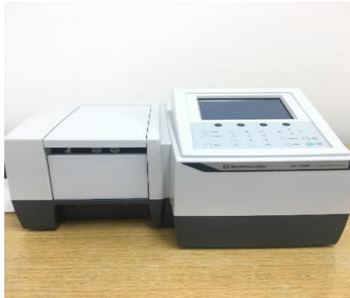
Slika 18. Spektrofotometar UV-1280 ( Shimadzu, Japan )
