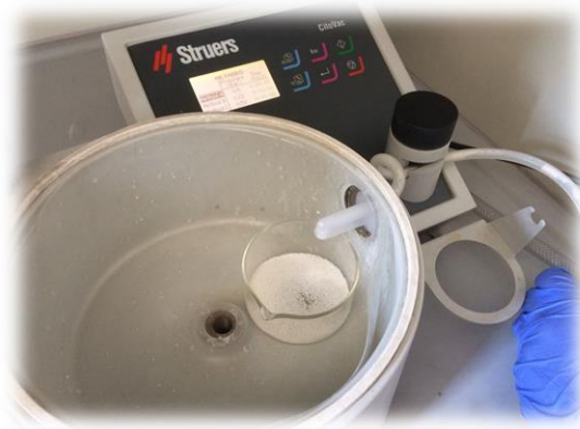
Slika 11. Uređaj za vakuumsku impregnaciju Cito Vac ( Struers )
