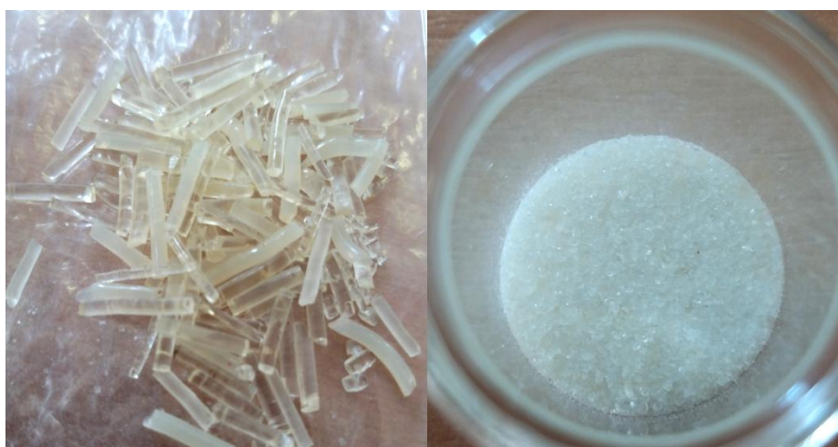
Slika 17. Uzorak CLX-SOL dobiven ekstrudiranjem pri 120 °C (CLX-SOL-120)
