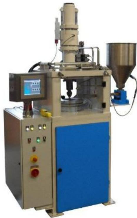
**Slika 2.** Klipni ekstruder <sup>[12]</sup>
