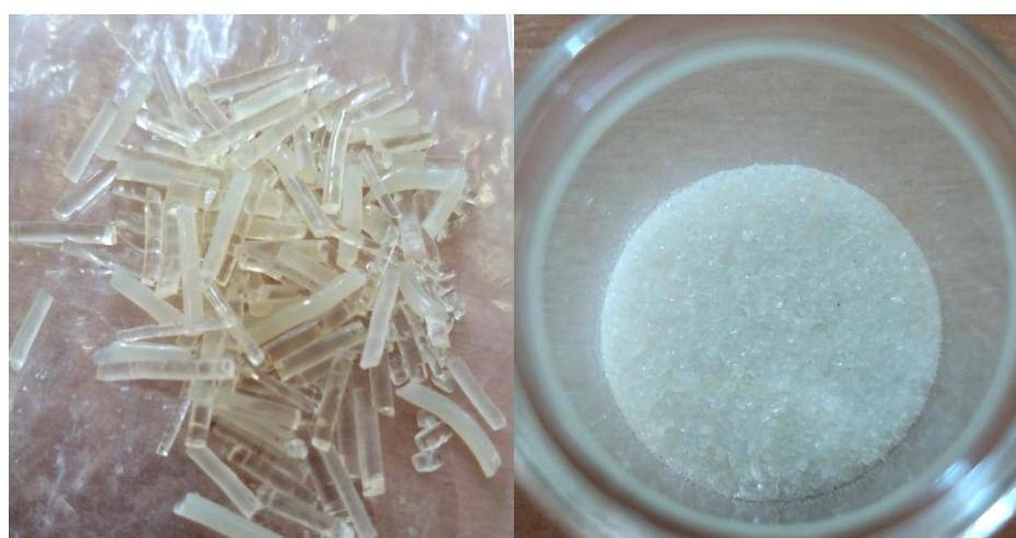
**Slika 17.** Uzorak CLX-SOL dobiven ekstrudiranjem pri 120 °C (CLX-SOL-120)
