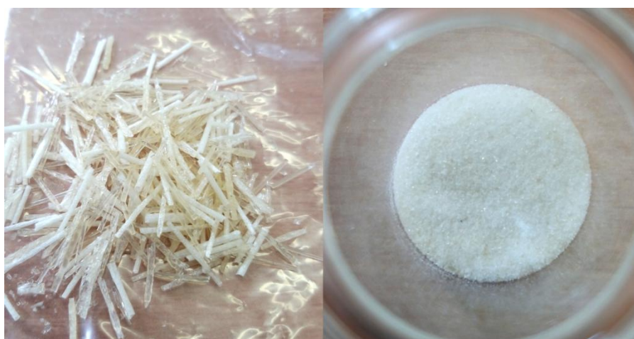
Slika 16. Uzorak CLX-SOL dobiven ekstrudiranjem pri 170 °C (CLX-SOL-170)
