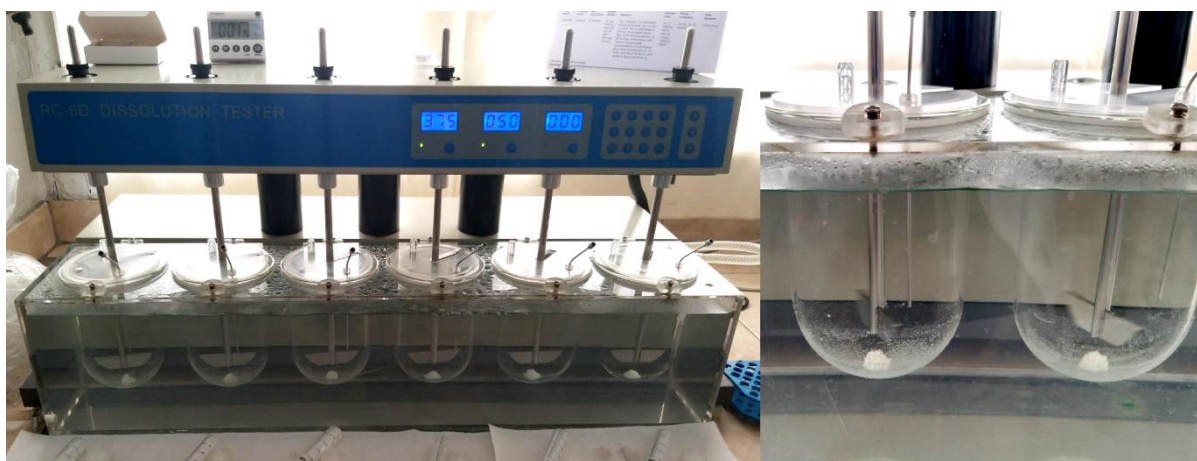
Slika 21. Uređaj za ispitivanje oslobađanja djelatnih tvari ( RC-6D , Zhengzhou Nanbei Instrument )
