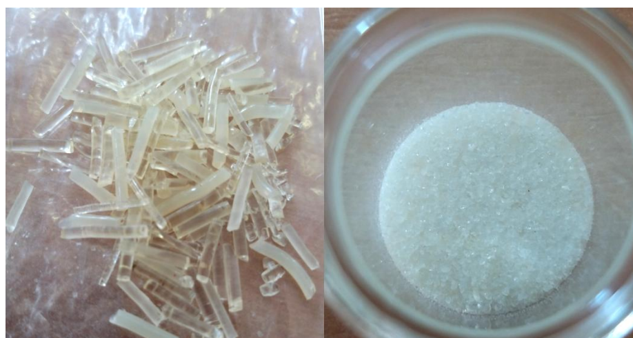
Slika 17. Uzorak CLX-SOL dobiven ekstrudiranjem pri 120 °C (CLX-SOL-120)
