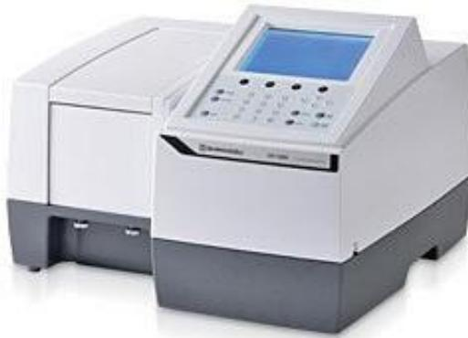
Slika 19. UV/Vis spektrofotometar (*UV-1280, Shimadzu*)
