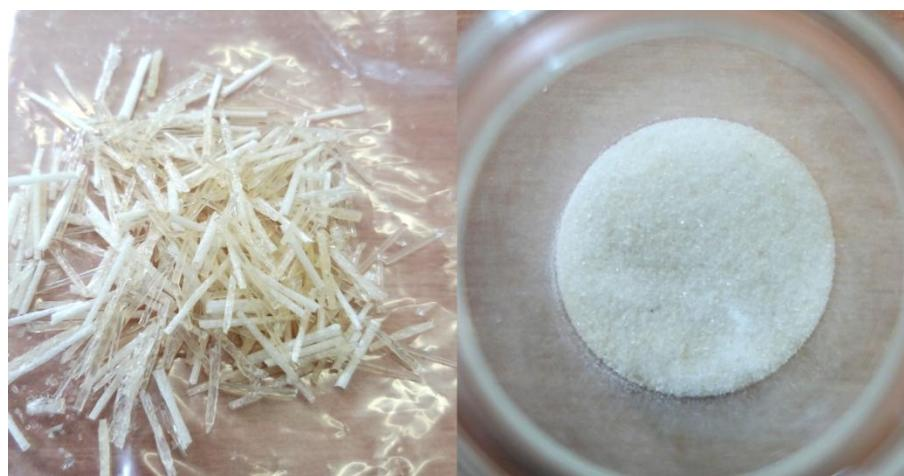
**Slika 16.** Uzorak CLX-SOL dobiven ekstrudiranjem pri 170 °C (CLX-SOL-170)
