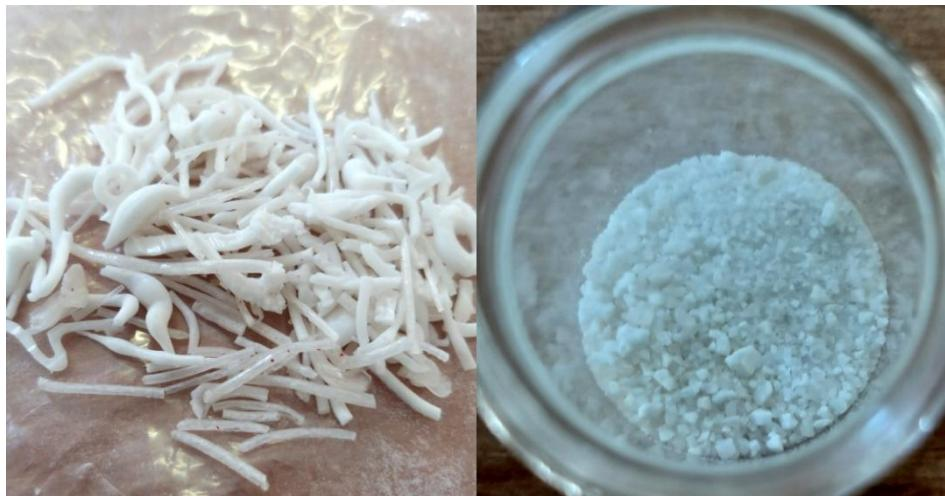
**Slika 18.** Uzorak CLX-PEG dobiven ekstrudiranjem pri  $57 - 61^{\circ}\text{C}$  (CLX-PEG-57-61)
