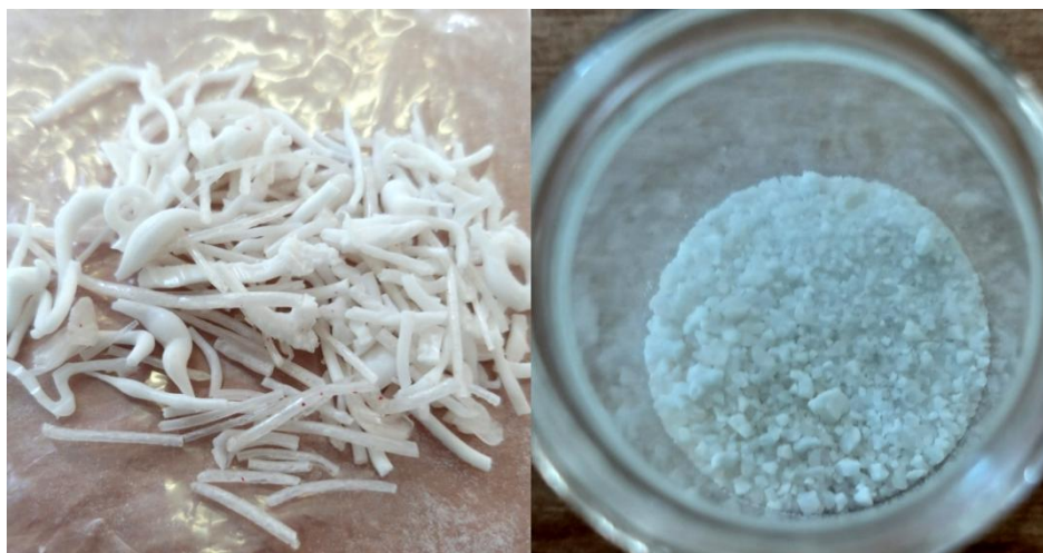
Slika 18. Uzorak CLX-PEG dobiven ekstrudiranjem pri 57 – 61 °C (CLX-PEG-57-61)
