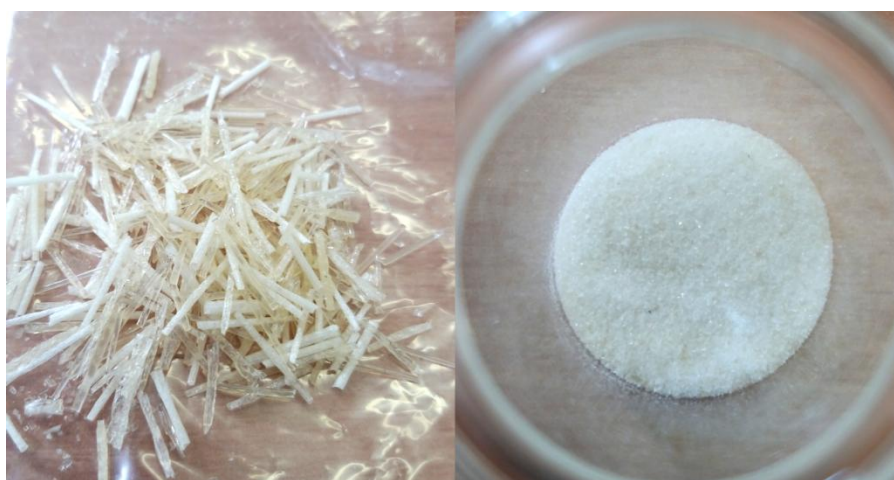
Slika 16. Uzorak CLX-SOL dobiven ekstrudiranjem pri 170 °C (CLX-SOL-170)
