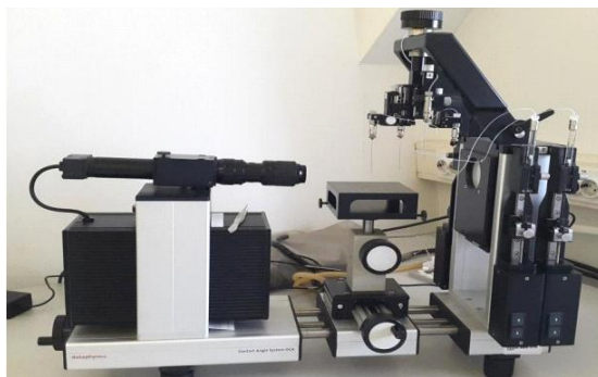
Slika 17. Goniometar, DataPhysics OCA 20 Instrument
