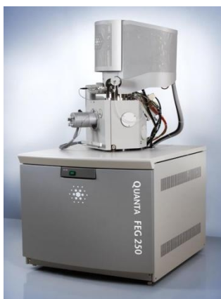
Slika 18. SEM mikroskop QUANTA 250, FEI
