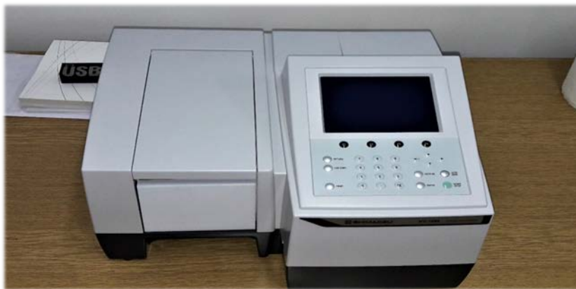
Slika 22. Fotografija spektrofotometra UV-1280 (Shimadzu, Kyoto, Japan)
