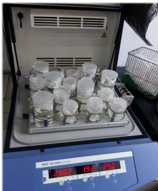
Slika 22. Fotografija laboratorijske tresilice IKA KS 3000 (IKA® -Werke GmbH & Co. KG, Staufen, SR Njemačka)
