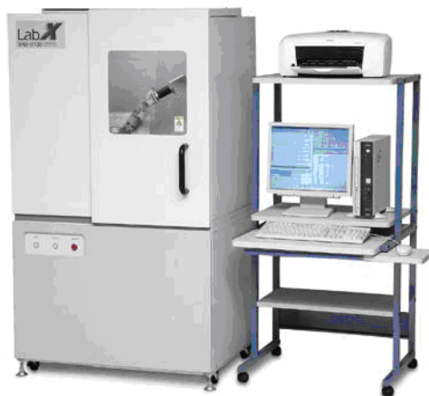
Slika 19. Fotografija uređaja za rendgensku difrakciju praha XRD-6300 (Shimadzu, Kyoto, Japan)
