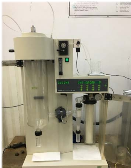
Slika 15. Fotografija laboratorijskog sušionika s raspršivanjem (BÜCHI Mini Spray-Dryer B-290)
