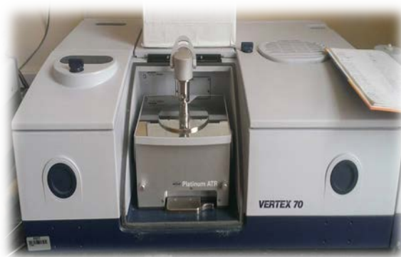
Slika 20. Fotografija FTIR spektrofotometra Vertex 70 s platinastim detektorom (Bruker, Billerica, SAD)
