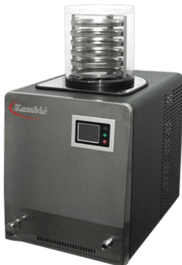
Slika 16. Fotografija liofilizatora LIO-5 PLT (Kambič, Semič, Republika Slovenija)
