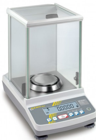
Slika 23. Fotografija analitičke vage KERN ALJ 220-4NM (KERN, Balingen, SR Njemačka)
