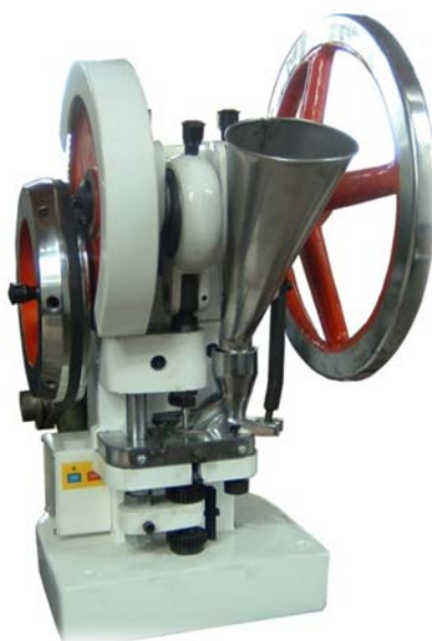
Slika 18. Fotografija uređaja za tabletiranje TDP-5T (Zhejiang Wisely Machinery Co., Ruian, NR Kina)
