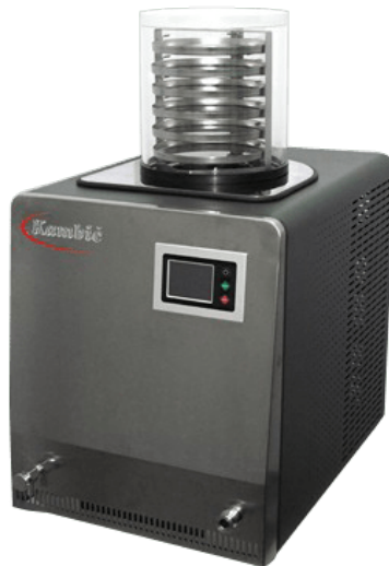
Slika 16. Fotografija liofilizatora LIO-5 PLT (Kambič, Semič, Republika Slovenija)
