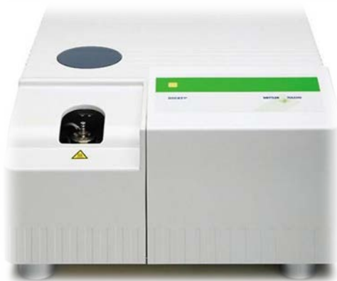
Slika 21. Fotografija diferencijalnog pretražnog kalorimetra Mettler Toledo 822° (Mettler Toledo GmbH, Greifensee, Švicarska)
