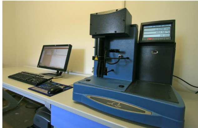
3.5.a) Shematski prikaz termovage; b) Termogravimetrijski analizator
