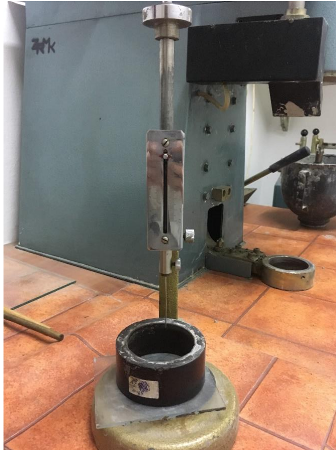
Slika 12: Vicat aparat za određivanje vremena vezanja
