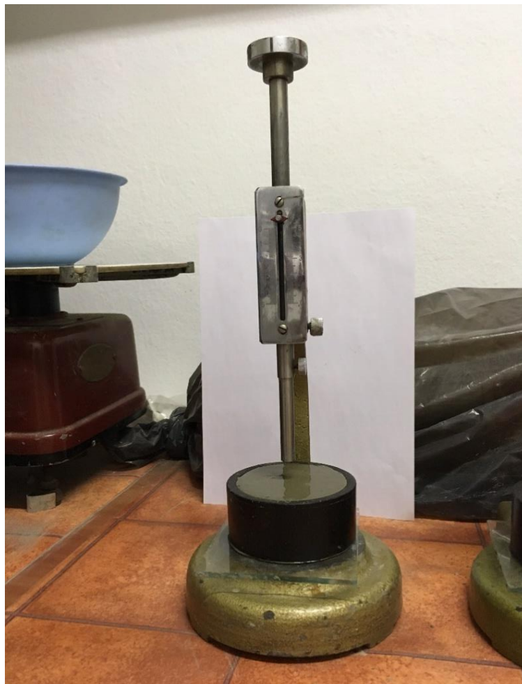
Slika 11: Aparat po Vicat-u za određivanje standardne konzistencije
