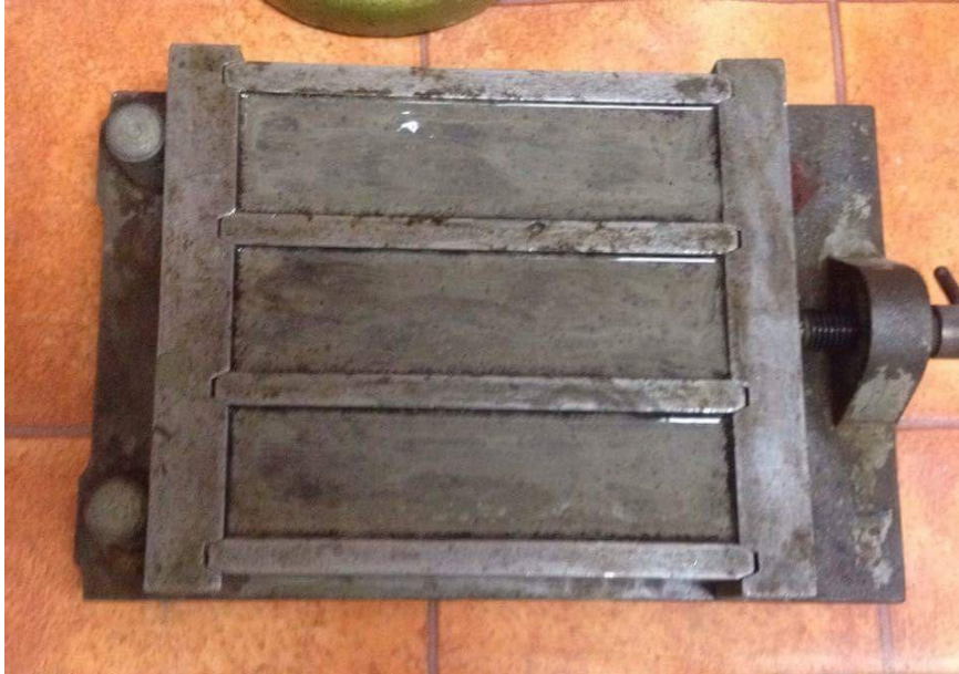
Slika 13: Trodiyelni kalup ispunjen cementnom pastom
