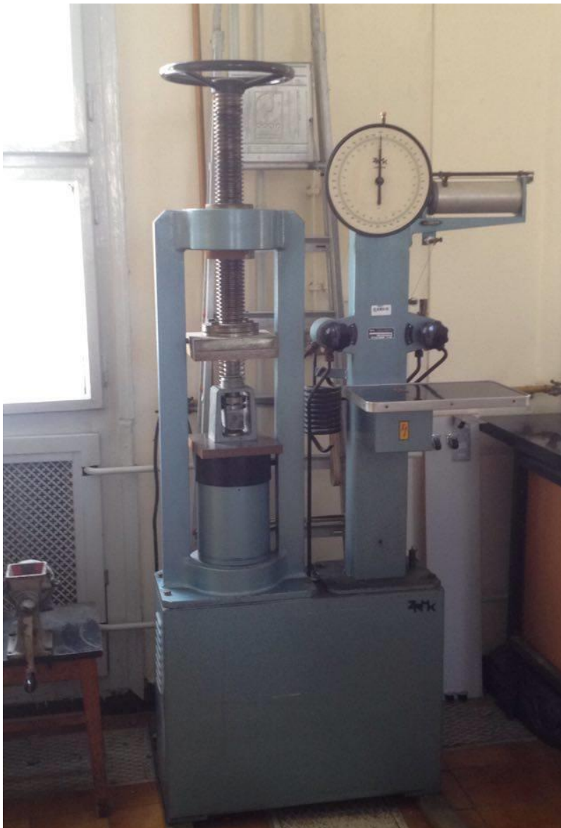
Slika 14: Hidraulična preša za određivanje čvrstoće na tlak
