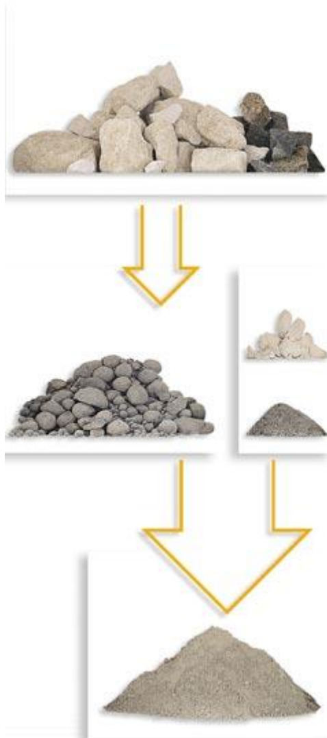
Slika 3: Proces proizvodnje cementa [12]
