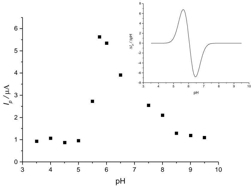
**Slika 60.** Ovisnost anodne vršne struje o pH vrijednosti medija. Eksperimentalni podaci interpolirani i obrađeni primjenom *Gauss*-ove funkcije. Umetak predstavlja prvu derivaciju prikazane krivulje.
