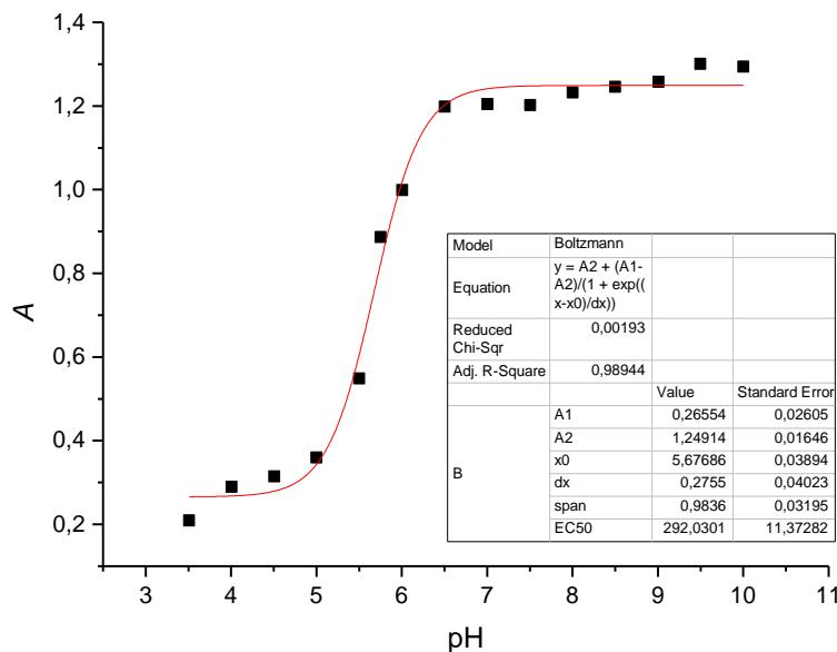
**Slika 71.** Grafički prikaz ovisnosti maksimalne apsorbancije o pH vrijednosti medija za uzorak tinte na bazi nanočestica srebra stabiliziranih s PAA,  $w(\text{AgNP-PAA}) = 3,62\%$ . Nanočestice dobivene taloženjem s 0,1 M  $\text{H}_2\text{C}_2\text{O}_4$ . Podaci obrađeni programom Origin primjenom funkcije Boltzmann-ove raspodjele.
