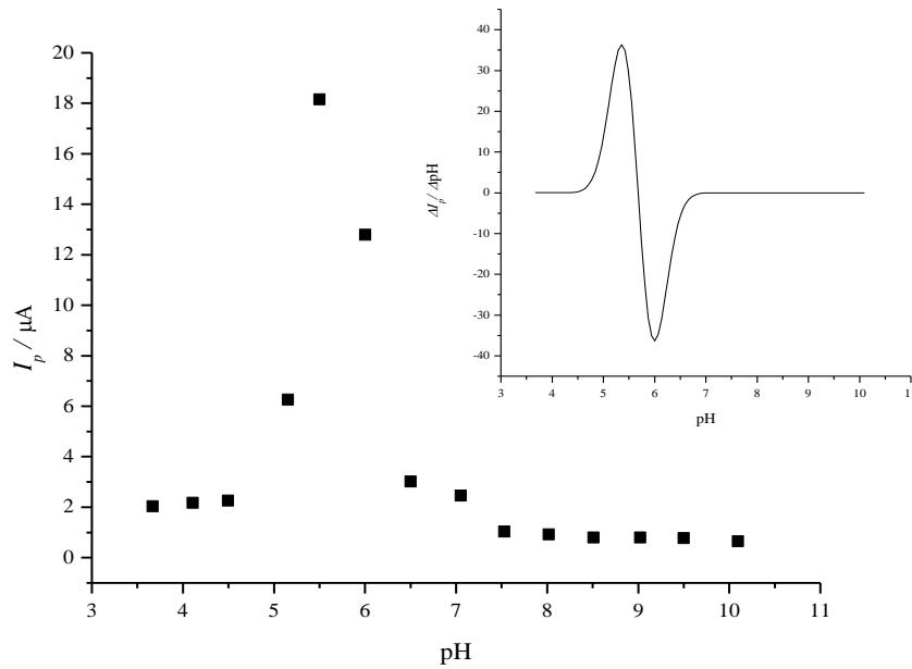
**Slika 20.** Ovisnost anodne vršne struje o pH vrijednosti medija. Eksperimentalni podaci interpolirani i obrađeni primjenom *Gauss*-ove funkcije. Umetak predstavlja prvu derivaciju prikazane krivulje.
