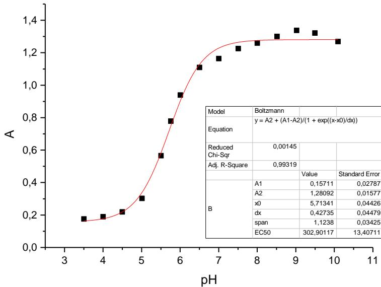
**Slika 43.** Grafički prikaz ovisnosti maksimalne apsorbancije o pH vrijednosti medija za uzorak tinte na bazi nanočestica srebra stabiliziranih s PAA,  $w(\text{AgNP-PAA}) = 3,62\%$ . Nanočestice dobivene taloženjem s 0,01 M  $\text{H}_2\text{C}_2\text{O}_4$ . Podaci obrađeni programom Origin primjenom Boltzmann-ove krivulje raspodjele.
