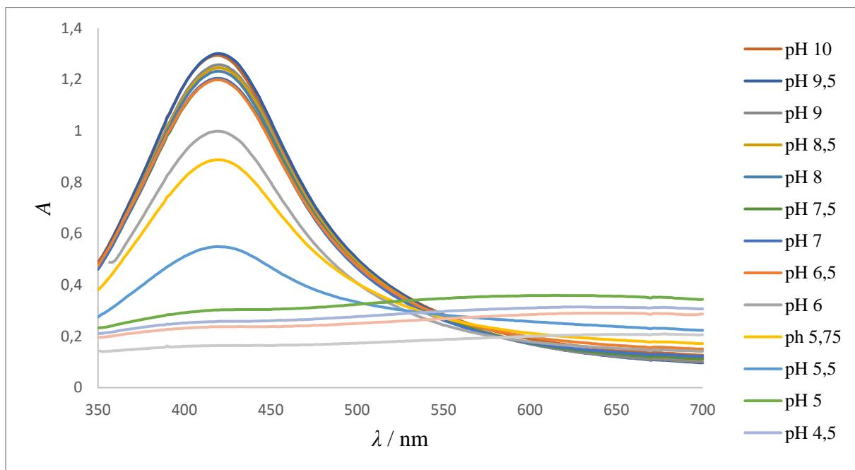
**Slika 70.** UV – Vis apsorpcijski spektri vodljive tinte na bazi nanočestica srebra stabiliziranih poli(akrilnom kiselinom), dobiveni taloženjem oksalnom kiselinom koncentracije 0,1 mol/dm<sup>3</sup>, u Britton – Robinsonovim puferima raspona pH vrijednosti od 10,00 do 3,50.
