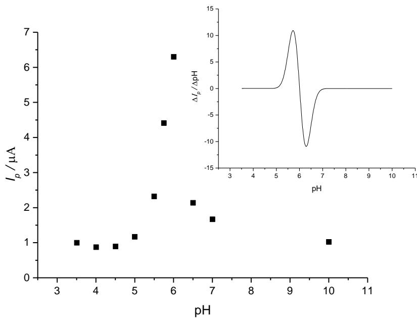
**Slika 48.** Ovisnost anodne vršne struje o pH vrijednosti medija. Eksperimentalni podaci interpolirani i obrađeni primjenom Gauss-ove funkcije. Umetak predstavlja prvu derivaciju prikazane krivulje.
