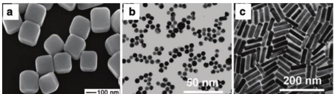
**Slika 2.** Prikaz različitih oblika nanočestica zlata snimljenih na transmisijskom elektronском mikroskopu (TEM). a) kocke, b) sfere, c) nanoštapići [13].
