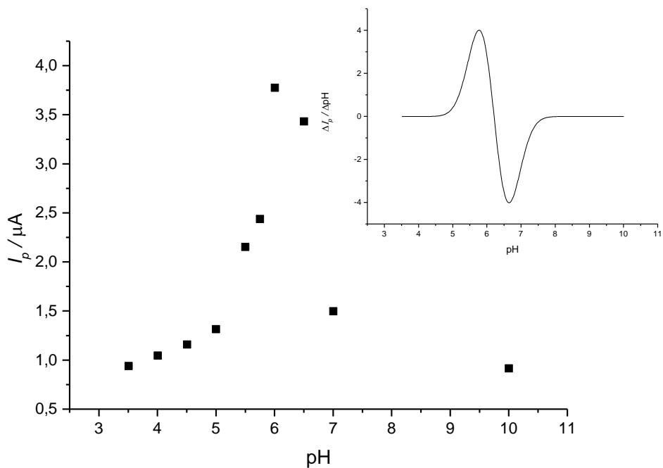
**Slika 52.** Ovisnost anodne vršne struje o pH vrijednosti medija. Eksperimentalni podaci interpolirani i obrađeni primjenom *Gauss*-ove funkcije. Umetak predstavlja prvu derivaciju prikazane krivulje.
