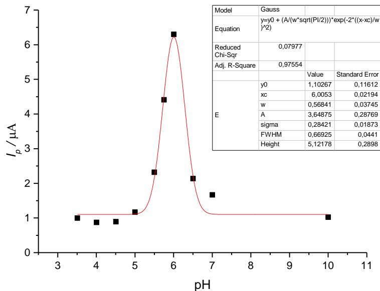
**Slika 47.** Grafički prikaz ovisnosti maksimalne anodne struje o pH vrijednosti medija za uzorak tinte na bazi nanočestica srebra stabiliziranih s PAA,  $w(\text{AgNP-PAA}) = 3,62\%$ . Nanočestice dobivene taloženjem s 0,1 M HClO<sub>4</sub>. Podaci obrađeni programom Origin uporabom Gauss-ove funkcije.
