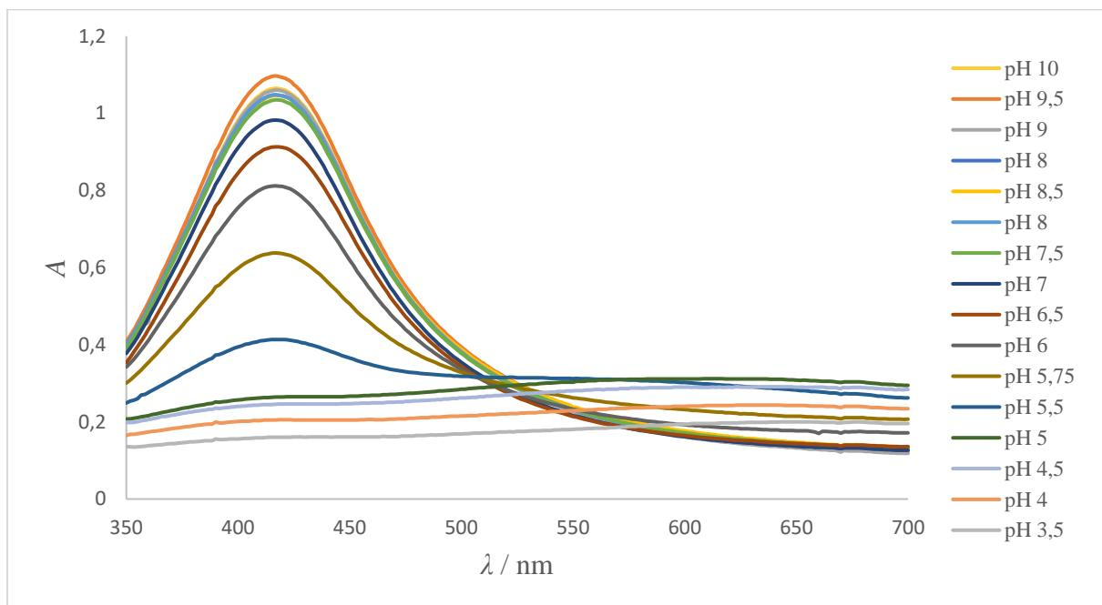
**Slika 67.** UV – Vis apsorpcijski spektri vodljive tinte na bazi nanočestica srebra stabiliziranih poli(akrilnom kiselinom), dobiveni taloženjem sumpornom kiselinom koncentracije 0,1 mol/dm<sup>3</sup>, u Britton – Robinsonovim puferima raspona pH vrijednosti od 10,00 do 3,50.
