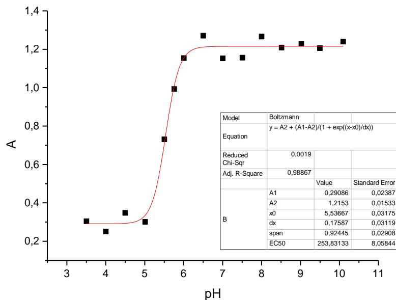
**Slika 37.** Grafički prikaz ovisnosti maksimalne apsorbancije o pH vrijednosti medija za uzorak tinte na bazi nanočestica srebra stabiliziranih s PAA,  $w(\text{AgNP-PAA}) = 3,62\%$ . Nanočestice dobivene taloženjem s 0,01 M  $\text{H}_3\text{PO}_4$ . Podaci obrađeni programom Origin primjenom funkcije *Boltzmann*-ove raspodjele.
