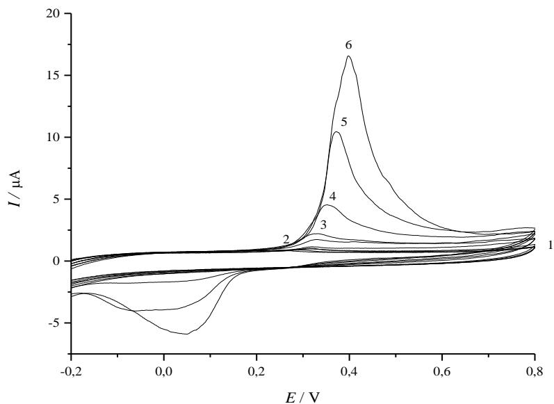
**Slika 25.** Ciklički voltamogrami dobiveni dodatkom  $50 \mu\text{L}$  AgNP-PAA tinte u  $10 \text{ mL}$  BR pufera u rasponu pH vrijednosti  $10,00 - 6,00$ . Taloženo s  $0,01 \text{ M}$   $\text{H}_2\text{SO}_4$ .
