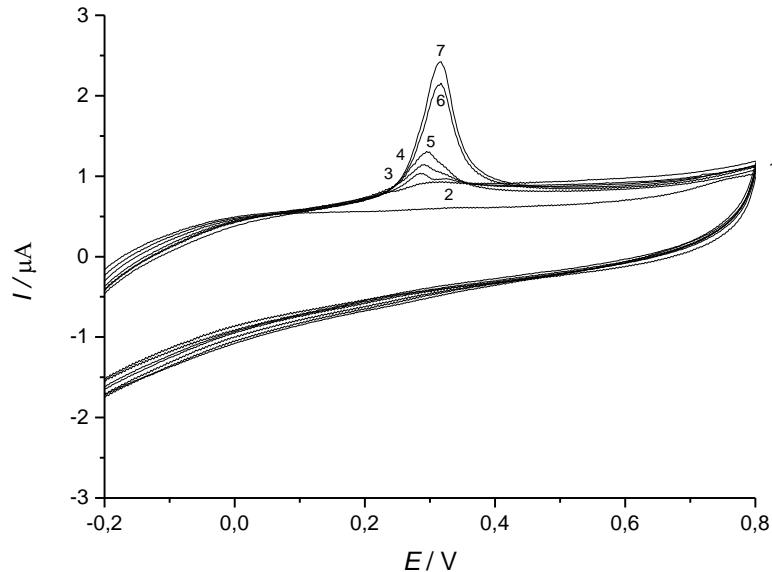
**Slika 50.** Ciklički voltamogrami dobiveni dodatkom  $50 \mu\text{L}$  vodljive tinte,  $w(\text{AgNP-PAA}) = 3,62\%$ , u  $10 \text{ mL}$  BR pufera raspona pH vrijednosti  $5,50 - 3,50$ . Taloženo s  $0,1 \text{ M H}_3\text{PO}_4$ .
