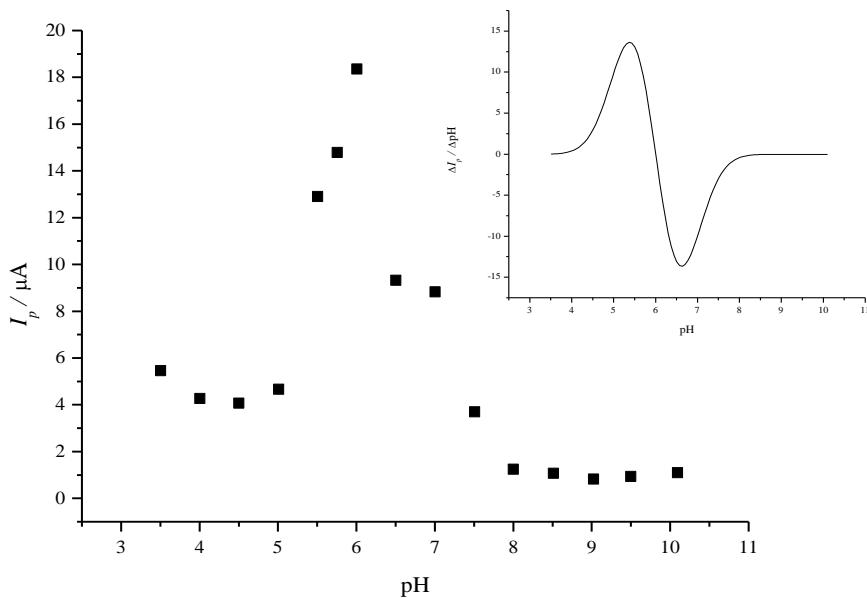
**Slika 32.** Ovisnost anodne vršne struje o pH vrijednosti medija. Eksperimentalni podaci interpolirani i obrađeni primjenom *Gauss*-ove funkcije. Umetak predstavlja prvu derivaciju prikazane krivulje.
