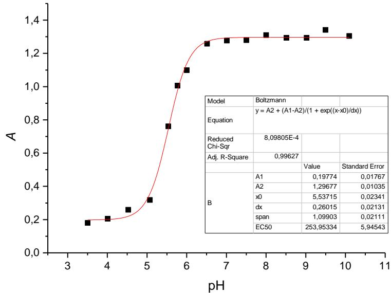
**Slika 62.** Grafički prikaz ovisnosti maksimalne apsorbancije o pH vrijednosti medija za uzorak tinte na bazi nanočestica srebra stabiliziranih s PAA,  $w(\text{AgNP-PAA}) = 3,62\%$ . Nanočestice dobivene taloženjem s 0,1 M HClO<sub>4</sub>. Podaci obrađeni programom Origin primjenom funkcije *Boltzmann*-ove raspodjele.
