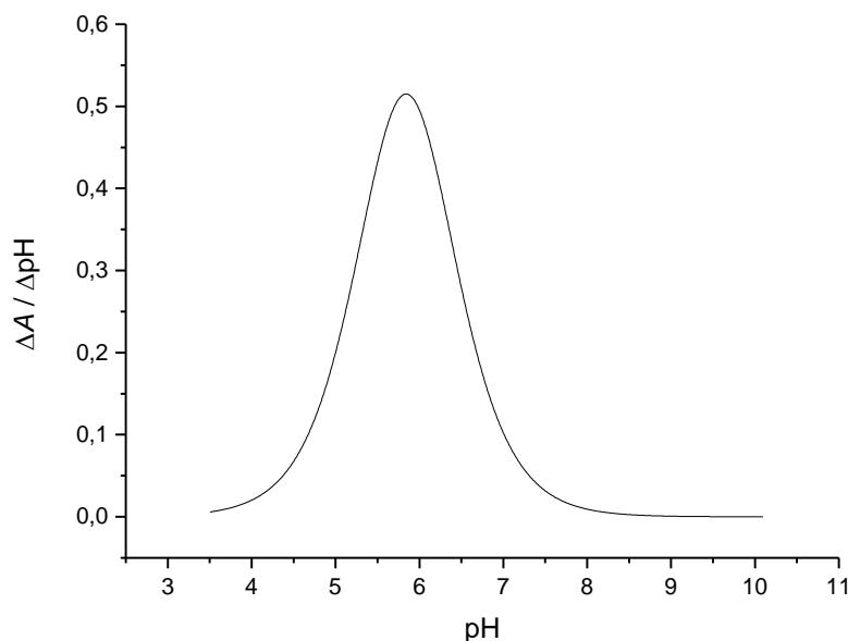
**Slika 66.** Grafički prikaz dobiven primjenom prve derivacije na krivulju koja prikazuje ovisnost maksimalne apsorbancije o pH za tinte na bazi nanočestica srebra taloženih fosfornom kiselinom koncentracije 0,1 M. Eksperimentalni podaci interpolirani i obrađeni programom Origin primjenom *Boltzmann*-ove funkcije.
