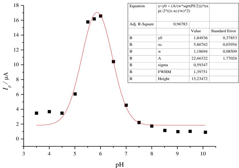
**Slika 27.** Grafički prikaz ovisnosti maksimalne anodne struje o pH vrijednosti medija za uzorak tinte na bazi nanočestica srebra stabiliziranih s PAA,  $w(\text{AgNP-PAA}) = 3,62\%$ . Nanočestice dobivene taloženjem s  $0,01 \text{ M H}_2\text{SO}_4$ . Podaci obrađeni programom Origin uporabom *Gauss*-ove funkcije.
