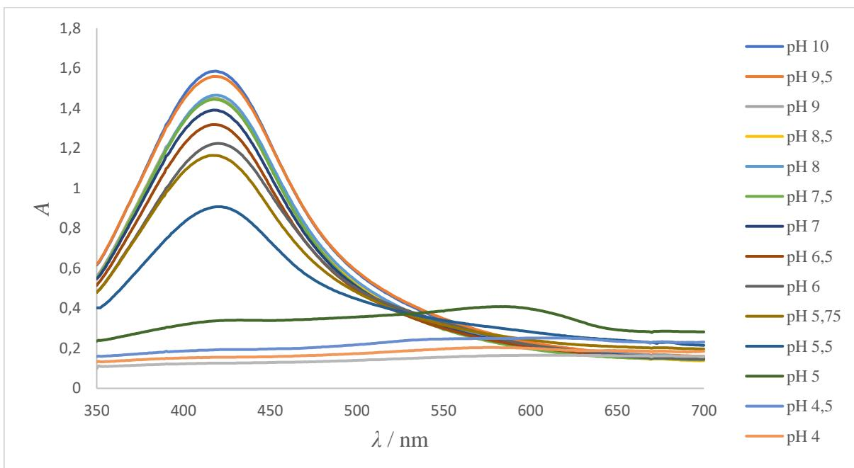
**Slika 39.** UV – Vis apsorpcijski spektri vodljive tinte na bazi nanočestica srebra stabiliziranih poli(akrilnom kiselinom), dobiveni taloženjem sumpornom kiselinom koncentracije 0,01 mol/dm<sup>3</sup>, u Britton – Robinsonovom puferu raspona pH vrijednosti od 10,00 do 3,50.
