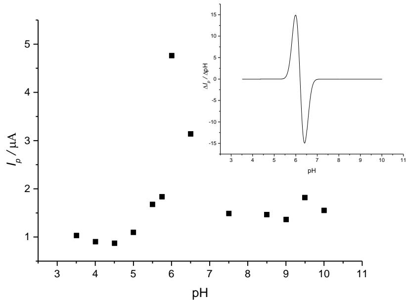
**Slika 56.** Ovisnost anodne vršne struje o pH vrijednosti medija. Eksperimentalni podaci interpolirani i obrađeni primjenom *Gauss*-ove funkcije. Umetak predstavlja prvu derivaciju prikazane krivulje.
