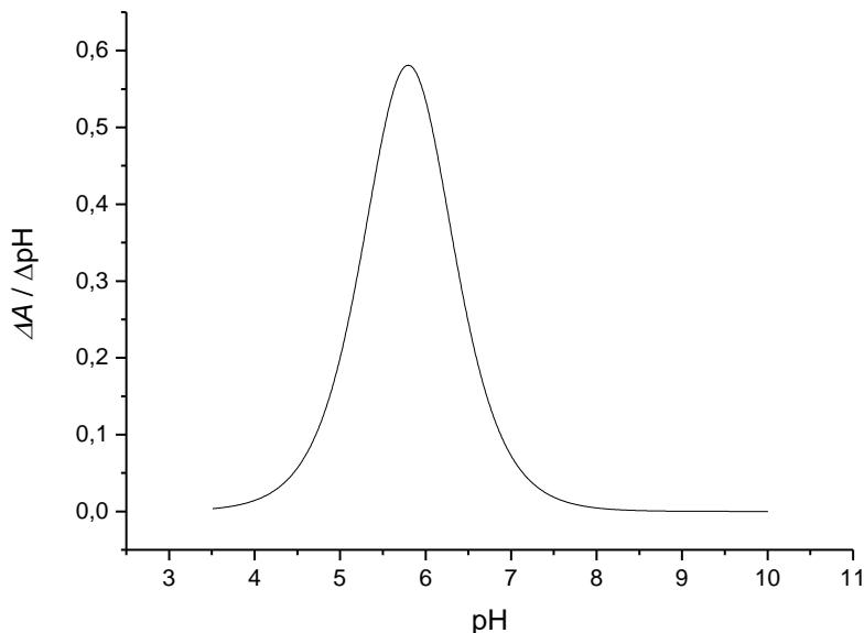
**Slika 69.** Grafički prikaz dobiven primjenom prve derivacije na krivulju koja prikazuje ovisnost maksimalne apsorbancije o pH za tinte na bazi nanočestica srebra taloženih sumpornom kiselinom koncentracije 0,1 M. Eksperimentalni podaci interpolirani i obrađeni programom Origin primjenom *Boltzmann*-ove funkcije.
