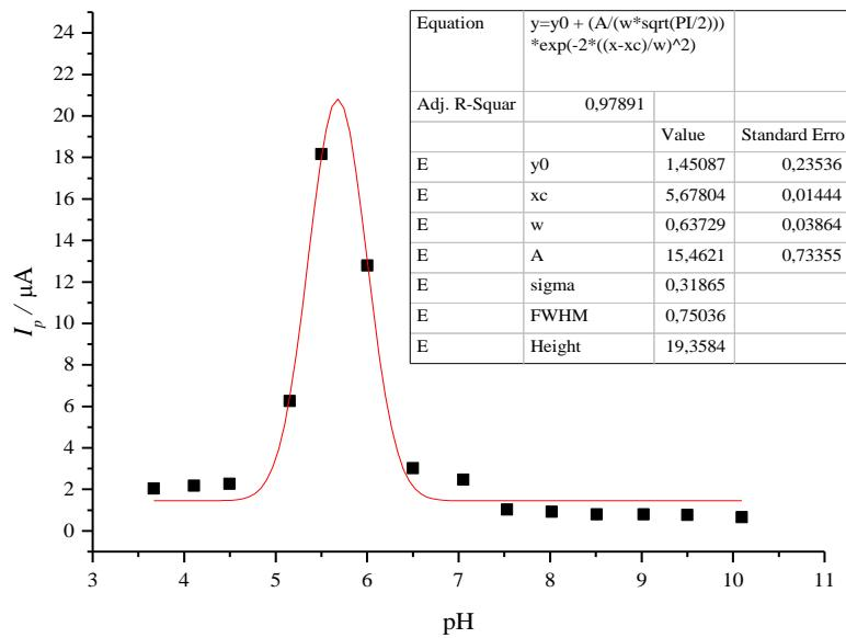
**Slika 19.** Grafički prikaz ovisnosti maksimalne anodne struje o pH vrijednosti medija za uzorak tinte na bazi nanočestica srebra stabiliziranih s PAA,  $w(\text{AgNP-PAA}) = 3,62\%$ . Nanočestice dobivene taloženjem s 0,01 M HClO<sub>4</sub>. Podaci obrađeni programom Origin uporabom *Gauss*-ove funkcije.
