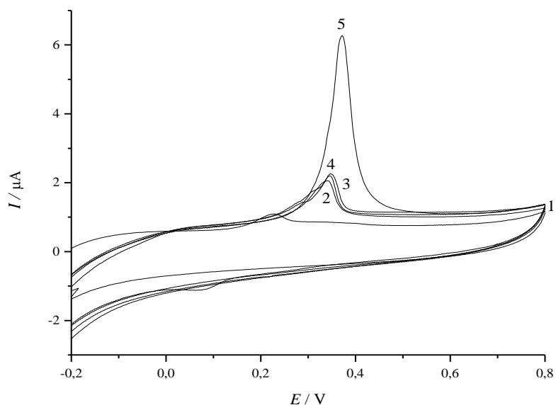
**Slika 18.** Ciklički voltamogrami dobiveni dodatkom  $50 \mu\text{L}$  vodljive tinte,  $w(\text{AgNP-PAA}) = 3,62\%$ , u  $10 \text{ mL}$  BR pufera raspona pH vrijednosti  $5,00 - 3,50$ . **1** – osnovni elektrolit; **5** – pH =  $5,00$ ; **4** – pH =  $4,50$ ; **3** – pH =  $4,00$ ; **2** – pH =  $3,50$ . Uvjeti snimanja kao na prethodnoj slici.
