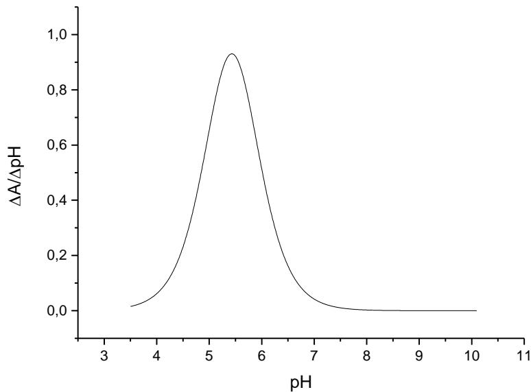
**Slika 41.** Grafički prikaz dobiven primjenom prve derivacije na krivulju koja prikazuje ovisnost maksimalne apsorbancije o pH za formulaciju tinte na bazi nanočestica srebra taloženih sumpornom kiselinom koncentracije  $0,01 \text{ M}$ . Eksperimentalni podaci interpolirani i obrađeni programom Origin primjenom Boltzmann-ove funkcije.
