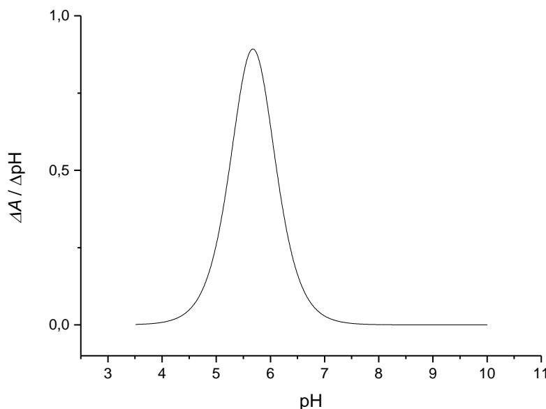
**Slika 72.** Grafički prikaz dobiven primjenom prve derivacije na krivulju koja prikazuje ovisnost maksimalne apsorbancije o pH za tinte na bazi nanočestica srebra taloženih oksalnom kiselinom koncentracije 0,1 M. Eksperimentalni podaci interpolirani i obrađeni programom Origin primjenom Boltzmann-ove funkcije.
