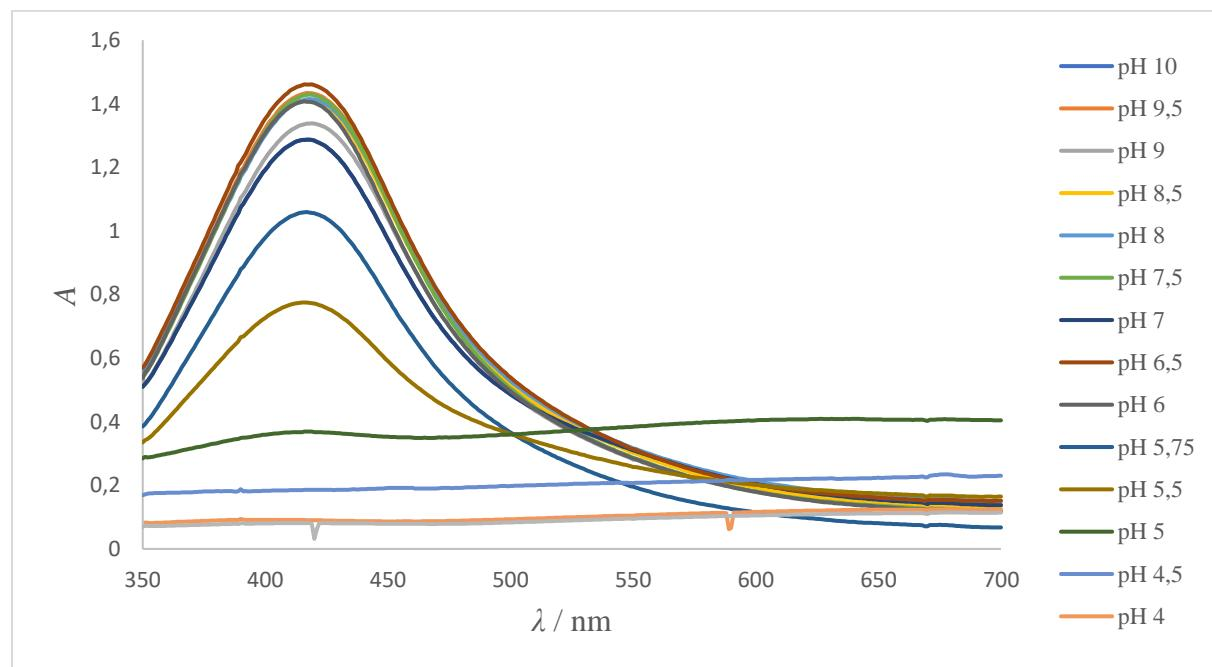
**Slika 33.** UV – Vis apsorpcijski spektri vodljive tinte na bazi nanočestica srebra stabiliziranih poli(akrilnom kiselinom), dobiveni taloženjem perklornom kiselinom koncentracije 0,01 mol/dm<sup>3</sup>, u Britton – Robinsonovom puferu raspona pH vrijednosti od 10,00 do 3,50.
