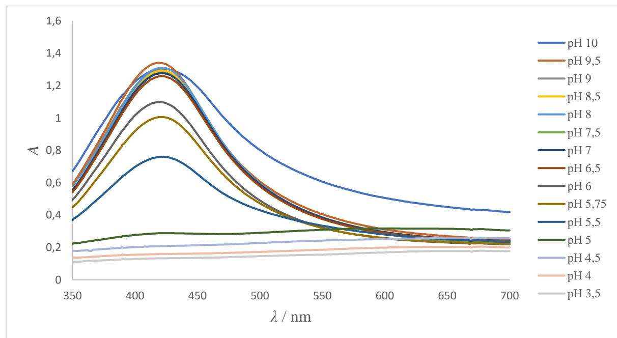
**Slika 61.** UV – Vis apsorpcijski spektri vodljive tinte na bazi nanočestica srebra stabiliziranih poli(akrilnom kiselinom), dobiveni taloženjem perklornom kiselinom koncentracije 0,1 mol/dm<sup>3</sup>, u Britton – Robinsonovim puferima raspona pH vrijednosti od 10,00 do 3,50.
