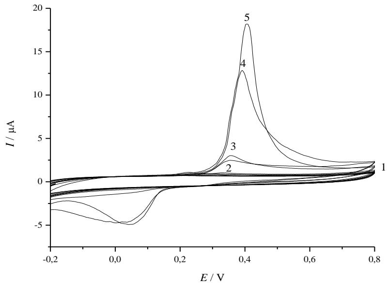
**Slika 17.** Ciklički voltamogrami dobiveni dodatkom  $50 \mu\text{L}$  vodljive tinte,  $w(\text{PAA} - \text{AgNP}) = 3,62\%$ , u  $10 \text{ mL}$  BR pufera u rasponu pH vrijednosti  $10,00 - 5,50$ .
