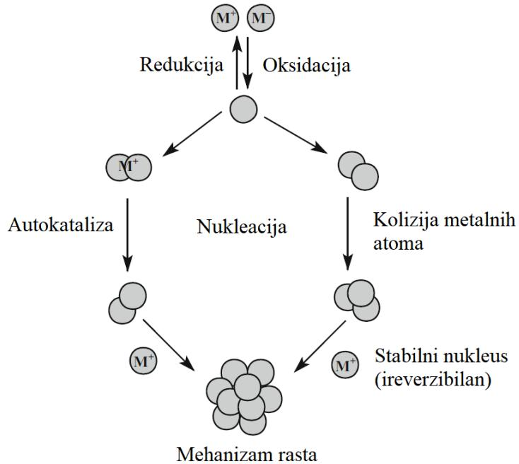
**Slika 6.** Mehanizam nukleacije i rasta nanočestica [12].
