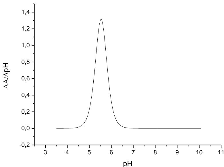
**Slika 38.** Grafički prikaz dobiven primjenom prve derivacije na krivulju koja prikazuje ovisnost maksimalne apsorbancije o pH za formulaciju tinte na bazi nanočestica srebra taloženih fosfornom kiselinom koncentracije 0,01 M. Eksperimentalni podaci interpolirani i obrađeni programom Origin primjenom *Boltzmann*-ove funkcije.
