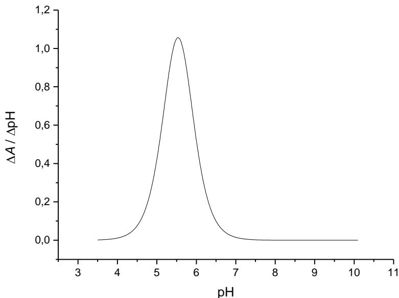
**Slika 63.** Grafički prikaz dobiven primjenom prve derivacije na krivulju koja prikazuje ovisnost maksimalne apsorbancije o pH za tinte na bazi nanočestica srebra taloženih perklornom kiselinom koncentracije 0,1 M. Eksperimentalni podaci interpolirani i obrađeni programom Origin primjenom *Boltzmann*-ove funkcije.
