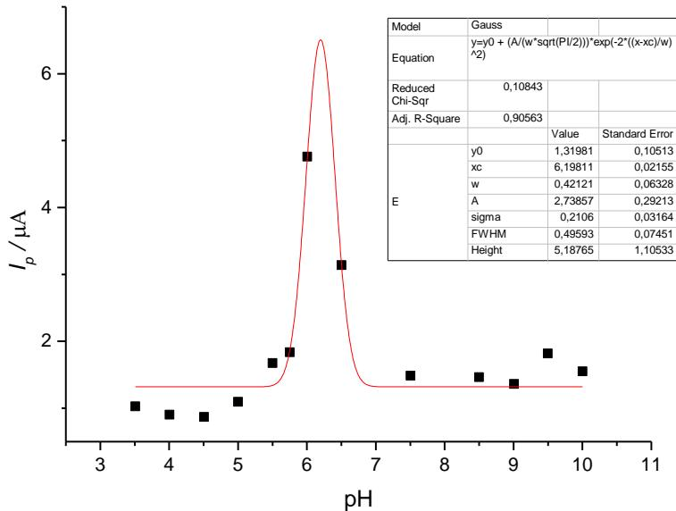
**Slika 55.** Grafički prikaz ovisnosti maksimalne anodne struje o pH vrijednosti medija za uzorak tinte na bazi nanočestica srebra stabiliziranih s PAA,  $w(\text{AgNP-PAA}) = 3,62\%$ . Nanočestice dobivene taloženjem s 0,1 M  $\text{H}_2\text{SO}_4$ . Podaci obrađeni programom Origin uporabom *Gauss*-ove funkcije.
