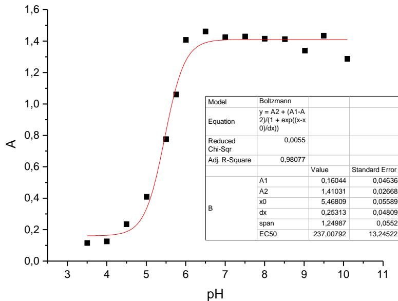
**Slika 34.** Grafički prikaz ovisnosti maksimalne apsorbancije o pH vrijednosti medija za uzorak tinte na bazi nanočestica srebra stabiliziranih s PAA,  $w(\text{AgNP-PAA}) = 3,62\%$ . Nanočestice dobivene taloženjem s 0,01 M HClO<sub>4</sub>. Podaci obrađeni programom Origin primjenom Boltzmann-ove raspodjele.
