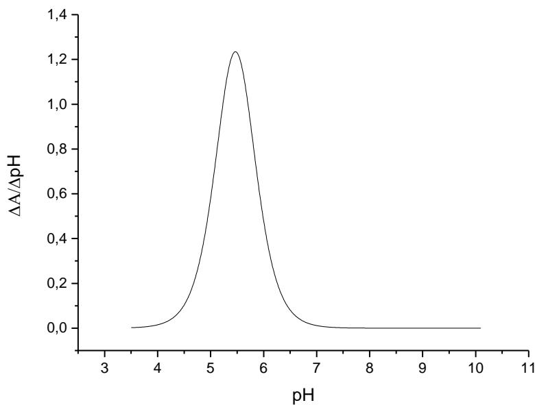
**Slika 35.** Grafički prikaz dobiven primjenom prve derivacije na krivulju koja prikazuje ovisnost maksimalne apsorbancije o pH za formulaciju tinte na bazi nanočestica srebra, taloženih perklornom kiselinom koncentracije 0,01 M. Eksperimentalni podaci interpolirani i obrađeni programom Origin primjenom Boltzmann-ove funkcije.
