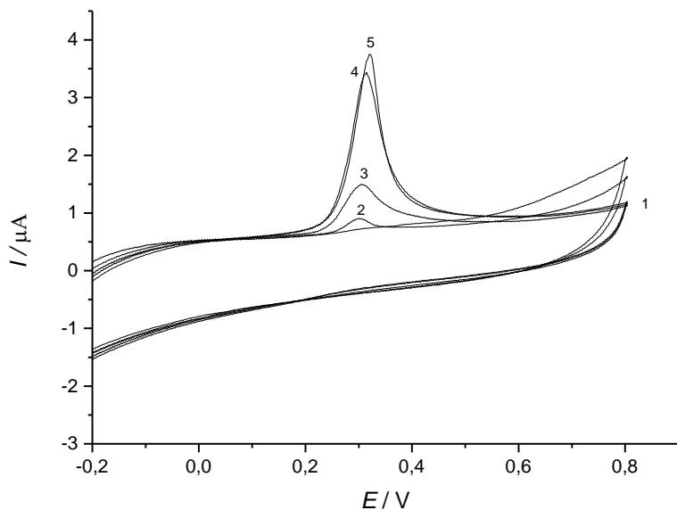
**Slika 49.** Ciklički voltamogrami dobiveni dodatkom 50  $\mu\text{L}$  AgNP-PAA tinte u 10 mL BR pufera u rasponu pH vrijednosti 10,00 – 6,00. Taloženo s 0,1 M  $\text{H}_3\text{PO}_4$ . **1** – osnovni elektrolit; **5** – pH = 6,00; **4** – pH = 6,50; **3** – pH = 7,00; **2** – pH = 10,00.
