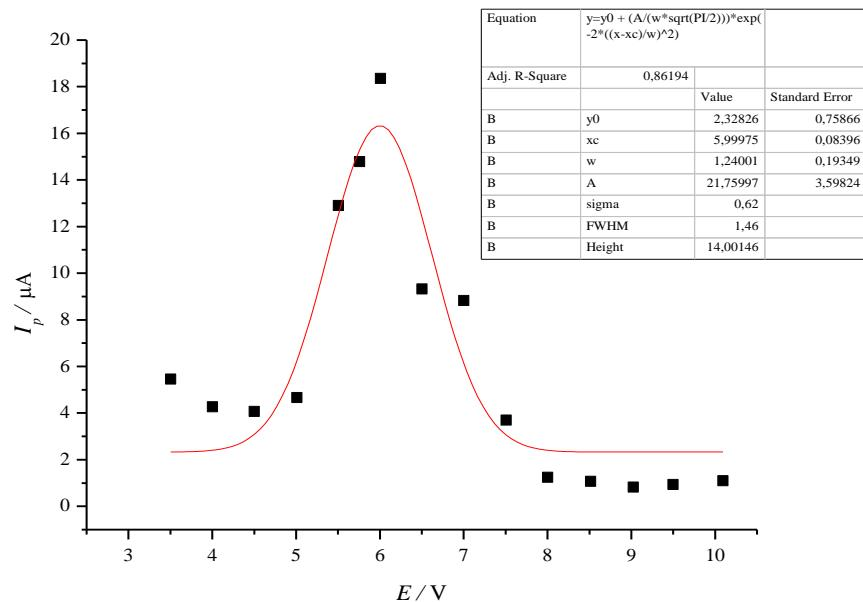
**Slika 31.** Grafički prikaz ovisnosti maksimalne anodne struje o pH vrijednosti medija za uzorak tinte na bazi nanočestica srebra stabiliziranih s PAA,  $w(\text{AgNP-PAA}) = 3,62\%$ . Nanočestice dobivene taloženjem s  $0,01 \text{ M} \text{ H}_2\text{C}_2\text{O}_4$ . Podaci obrađeni programom Origin uporabom funkcije *Gauss*-ove funkcije.
