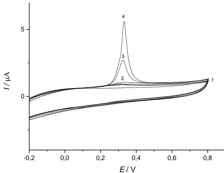
**Slika 58.** Ciklički voltamogrami dobiveni dodatkom  $50 \mu L$  vodljive tinte,  $w(\text{AgNP-PAA}) = 3,62\%$ , u  $10 \text{ mL}$  BR pufera raspona pH vrijednosti  $5,75 - 3,50$ . Taloženo s  $0,1 \text{ M}$   $\text{H}_2\text{C}_2\text{O}_4$ .
