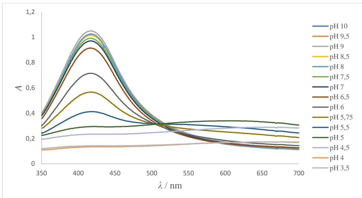
**Slika 64.** UV – Vis apsorpcijski spektri vodljive tinte na bazi nanočestica srebra stabiliziranih poli(akrilnom kiselinom), dobiveni taloženjem fosfornom kiselinom koncentracije 0,1 mol/dm<sup>3</sup>, u Britton – Robinsonovim puferima raspona pH vrijednosti od 10,00 do 3,50.
