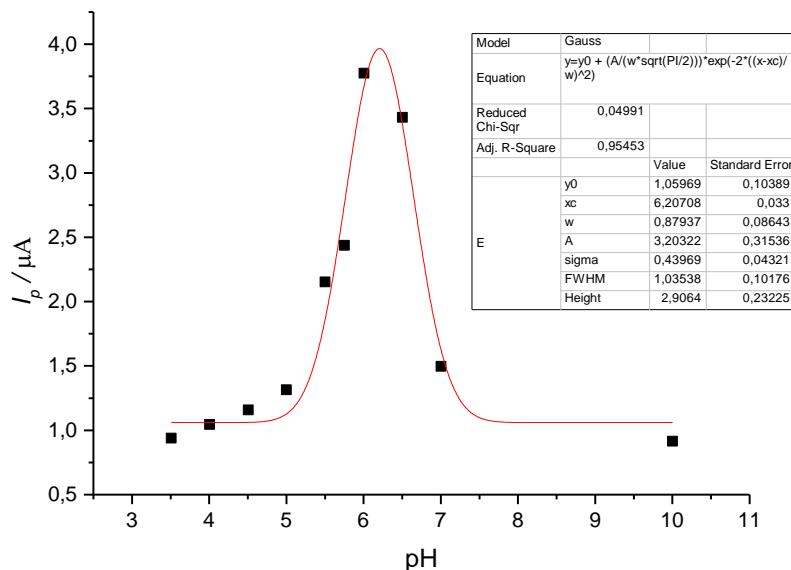
**Slika 51.** Grafički prikaz ovisnosti maksimalne anodne struje o pH vrijednosti medija za uzorak tinte na bazi nanočestica srebra stabiliziranih s PAA,  $w(\text{AgNP-PAA}) = 3,62\%$ . Nanočestice dobivene taloženjem s  $0,1 \text{ M H}_3\text{PO}_4$ . Podaci obrađeni programom Origin uporabom *Gauss*-ove funkcije.
