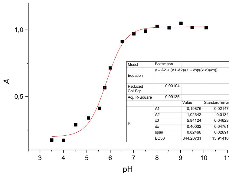
**Slika 65.** Grafički prikaz ovisnosti maksimalne apsorbancije o pH vrijednosti medija za uzorak tinte na bazi nanočestica srebra stabiliziranih s PAA,  $w(\text{AgNP-PAA}) = 3,62\%$ . Nanočestice dobivene taloženjem s 0,1 M  $\text{H}_3\text{PO}_4$ . Podaci obrađeni programom Origin primjenom funkcije *Boltzmann*-ove raspodjele.
