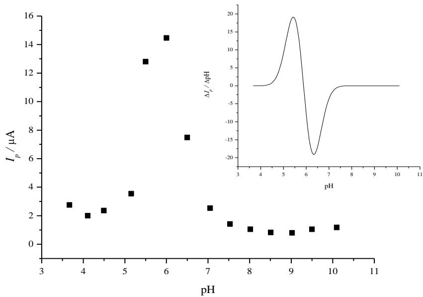
**Slika 24.** Ovisnost anodne vršne struje o pH vrijednosti medija. Eksperimentalni podaci interpolirani i obrađeni primjenom *Gauss*-ove funkcije. Umetak predstavlja prvu derivaciju prikazane krivulje.
