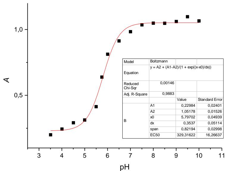
**Slika 68.** Grafički prikaz ovisnosti maksimalne apsorbancije o pH vrijednosti medija za uzorak tinte na bazi nanočestica srebra stabiliziranih s PAA,  $w(\text{AgNP-PAA}) = 3,62\%$ . Nanočestice dobivene taloženjem s 0,1 M  $\text{H}_2\text{SO}_4$ . Podaci obrađeni programom Origin primjenom funkcije *Boltzmann*-ove raspodjele.
