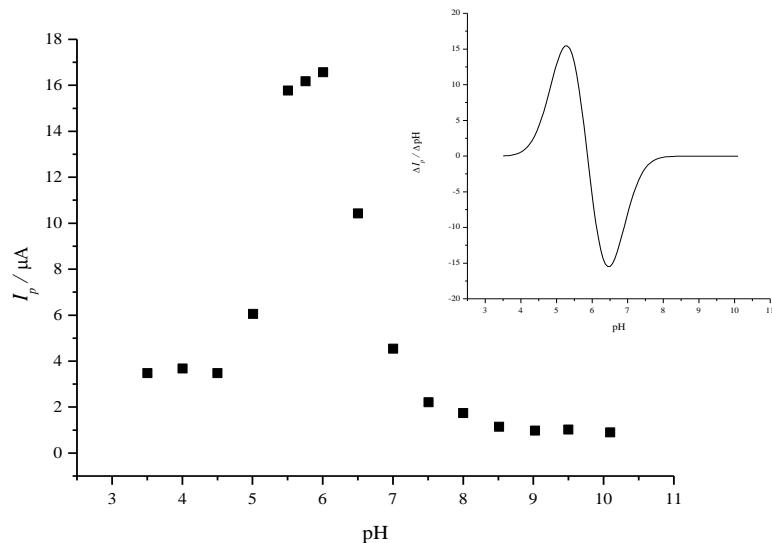
**Slika 28.** Ovisnost anodne vršne struje o pH vrijednosti medija. Eksperimentalni podaci interpolirani i obrađeni primjenom *Gauss*-ove funkcije. Umetak predstavlja prvu derivaciju prikazane krivulje.
