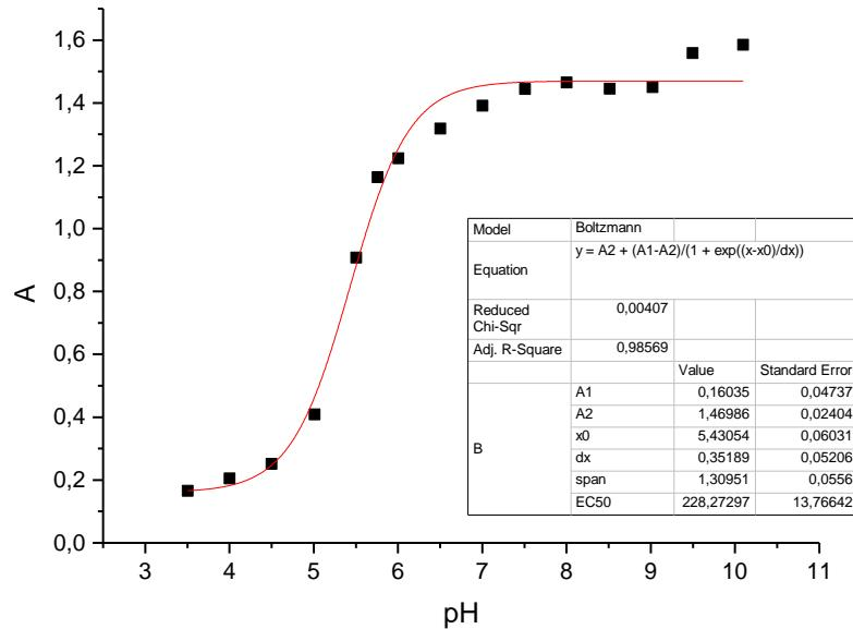
**Slika 40.** Grafički prikaz ovisnosti maksimalne apsorbancije o pH vrijednosti medija za uzorak tinte na bazi nanočestica srebra stabiliziranih s PAA,  $w(\text{AgNP-PAA}) = 3,62\%$ . Nanočestice dobivene taloženjem s  $0,01 \text{ M H}_2\text{SO}_4$ . Podaci obrađeni programom Origin primjenom Boltzmann-ove krivulje raspodjele.
