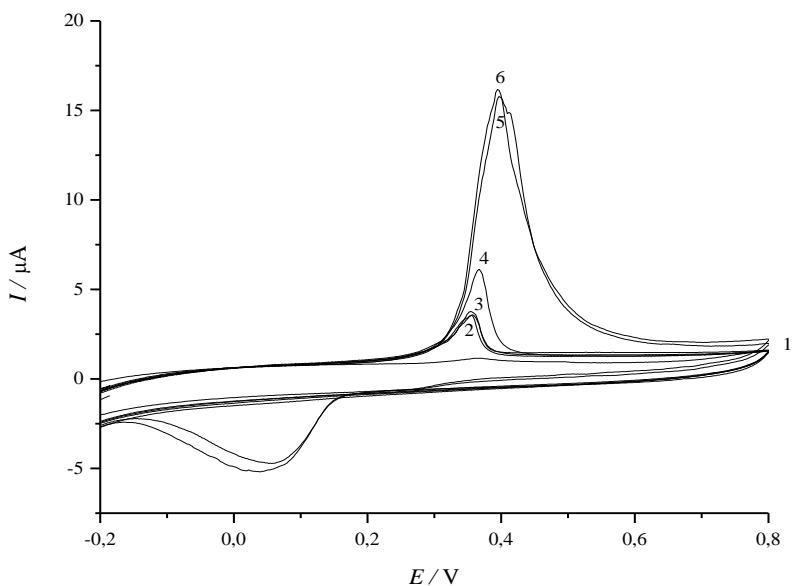
**Slika 26.** Ciklički voltamogrami dobiveni dodatkom  $50 \mu\text{L}$  vodljive tinte,  $w(\text{AgNP-PAA}) = 3,62\%$ , u  $10 \text{ mL}$  BR pufera raspona pH vrijednosti  $5,75 - 3,50$ , taloženo s  $0,01 \text{ M}$   $\text{H}_2\text{SO}_4$ .
