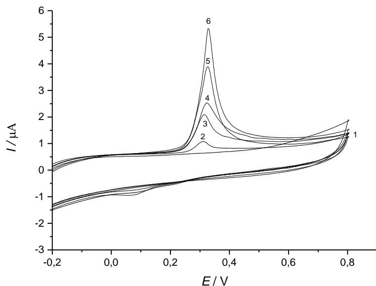
**Slika 57.** Ciklički voltamogrami dobiveni dodatkom 50  $\mu\text{L}$  AgNP-PAA tinte u 10 mL BR pufera u rasponu pH vrijednosti 10,00 – 6,00. Taloženo s 0,1 M  $\text{H}_2\text{C}_2\text{O}_4$ . **1** – osnovni elektrolit; **6** – pH = 6,00; **5** – pH = 6,50; **4** – pH = 7,50; **3** – pH = 8,00; **2** – pH = 9,50.
