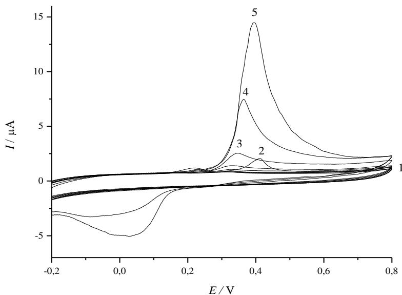
**Slika 21.** Ciklički voltamogrami dobiveni dodatkom  $50 \mu\text{L}$  (AgNP-PAA) tinte u  $10 \text{ mL}$  BR pufera u rasponu pH vrijednosti  $10,00 - 6,00$ . **1** – BR puferi  $\text{pH} = 10,00 - 7,50$  ;
