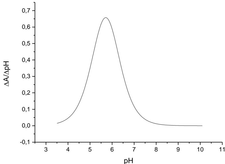
**Slika 44.** Grafički prikaz dobiven primjenom prve derivacije na krivulju koja prikazuje ovisnost maksimalne apsorbancije o pH za formulaciju tinte na bazi nanočestica srebra taloženih oksalnom kiselinom koncentracije 0,01 M. Eksperimentalni podaci interpolirani i obrađeni programom Origin primjenom Boltzmann-ove funkcije.
