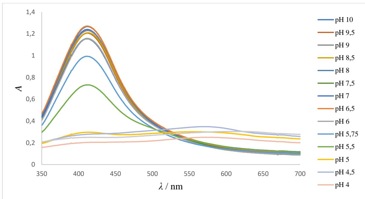
**Slika 36.** UV – Vis apsorpcijski spektri vodljive tinte na bazi nanočestica srebra stabiliziranih poli(akrilnom kiselinom), dobiveni taloženjem fosfornom kiselinom koncentracije 0,01 mol/dm<sup>3</sup>, u Britton – Robinsonovim puferima raspona pH vrijednosti od 10,00 do 3,50.
