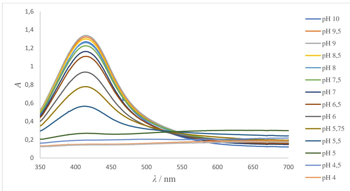
**Slika 42.** UV – Vis apsorpcijski spektri vodljive tinte na bazi nanočestica srebra stabiliziranih poli(akrilnom kiselinom), dobiveni taloženjem oksalnom kiselinom koncentracije 0,01 mol/dm<sup>3</sup>, u Britton – Robinsonovim puferima raspona pH vrijednosti od 10,00 do 3,50.
