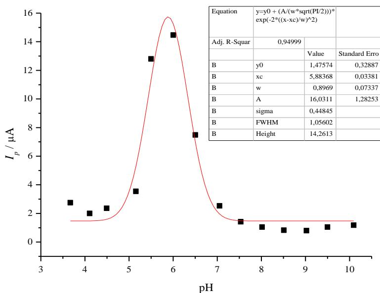
**Slika 23.** Grafički prikaz ovisnosti maksimalne anodne struje o pH vrijednosti medija za uzorak tinte na bazi nanočestica srebra stabiliziranih s PAA,  $w(\text{PAA-AgNP}) = 3,62\%$ . Nanočestice dobivene taloženjem s  $0,01 \text{ M} \text{ H}_3\text{PO}_4$ . Podaci obrađeni programom Origin uporabom *Gauss-ove funkcije*.
