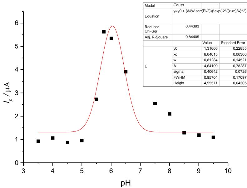
**Slika 59.** Grafički prikaz ovisnosti maksimalne anodne struje o pH vrijednosti medija za uzorak tinte na bazi nanočestica srebra stabiliziranih s PAA,  $w(\text{AgNP-PAA}) = 3,62\%$ . Nanočestice dobivene taloženjem s  $0,1 \text{ M}$   $\text{H}_2\text{C}_2\text{O}_4$ . Podaci obrađeni programom Origin uporabom Gauss-ove funkcije.
