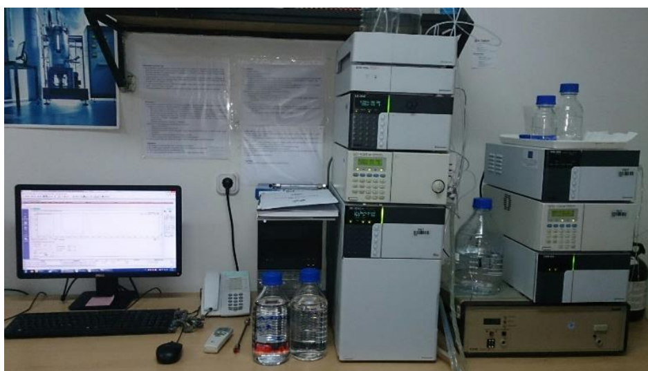
Slika 17. Uređaj za tekućinsku kromatografiju visoke djelotvornosti (HPLC).
