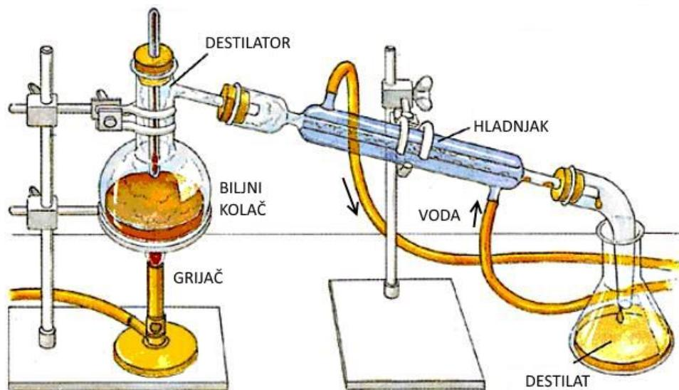
Slika 1.1. Oprema za provedbu destilacije u laboratorijskom mjerilu<sup>2</sup>
