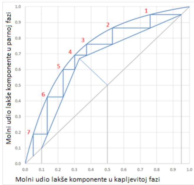
Slika 2.10. Princip određivanja broja teorijskih stupnjeva<sup>6</sup>
