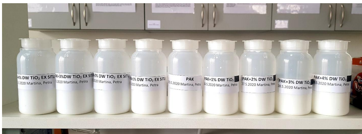
Slika 20. PAK i PAK/TiO 2 emulzije pripravljene in situ polimerizacijom i ex situ načinom pripreve
