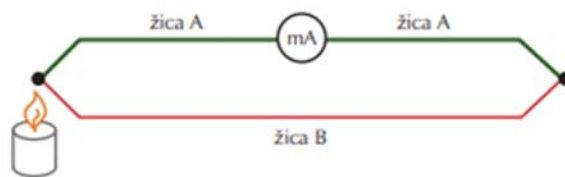
Slika 4. Shematski prikaz termopara (spoj dva različita metala)
