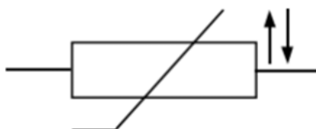
Slika 7. simbol NTC otpornika
