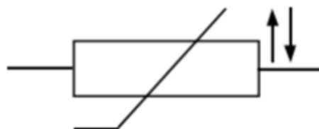
Slika 7. simbol NTC otpornika
