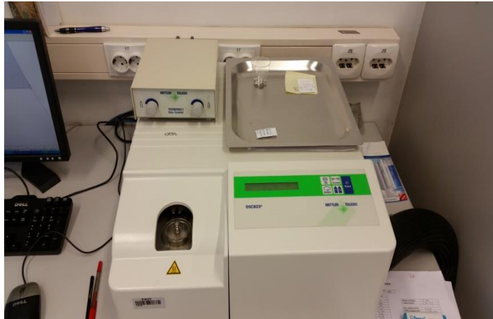
Slika 14. Fotografija diferencijalnog pretražnog kalorimetra Mettler Toledo 822° (Mettler Toledo, Columbus, Sjedinjene Američke Države)
