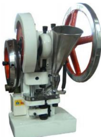
Slika 20. Fotografija uređaja za tabletiranje TDP-5T (Zhejiang Wisely Machinery Co.)
