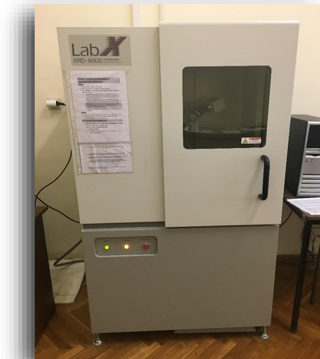
Slika 16. Fotografija uređaja za rendgensku difrakciju XRD 600 (Shimadzu, Kyoto, Japan)
