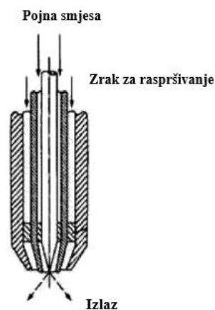
Slika 6. Konstrukcija pneumatskih mlaznica
