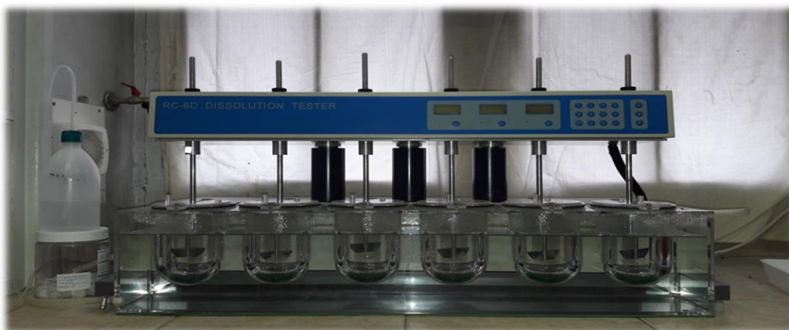
Slika 25. Fotografija uređaja za ispitivanje oslobađanja djelatne tvari RC-6D (Zhengzhou Nanbei Instrument, Henan, NR Kina)
