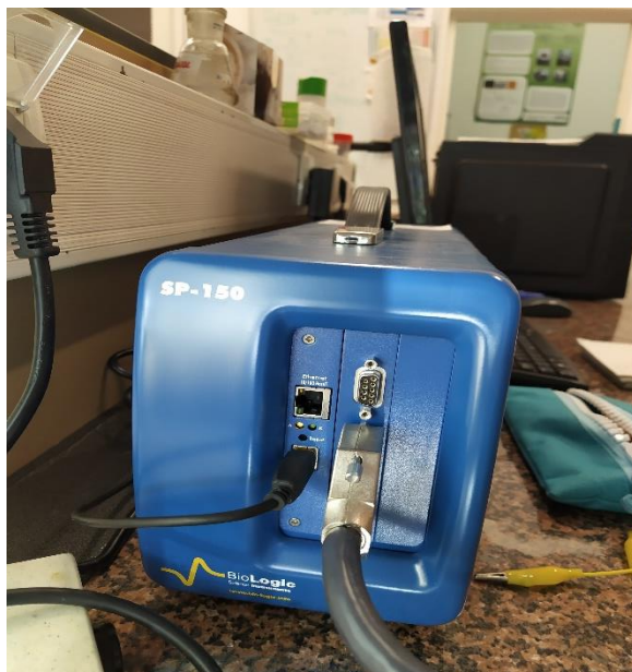
Slika 14. Potenciostat SP-150 BioLogic
