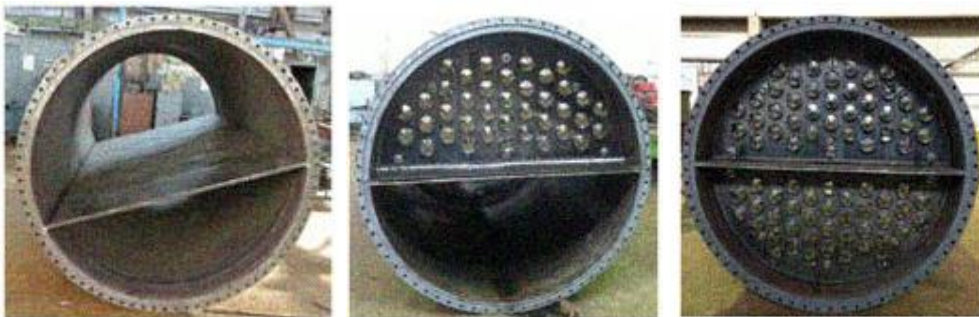
Slika 3.6. Instalirana razdjelna stijenka i unutrašnjost kolone ispunjena pliticama u DWC [12].
