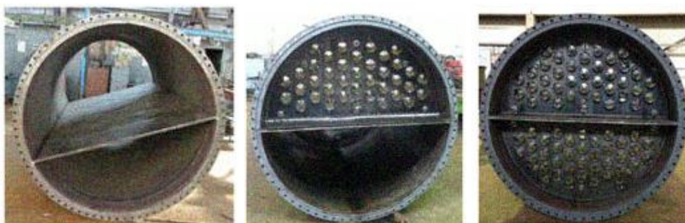
Slika 3.6. Instalirana razdjelna stijenka i unutrašnjost kolone ispunjena pliticama u DWC [12].
