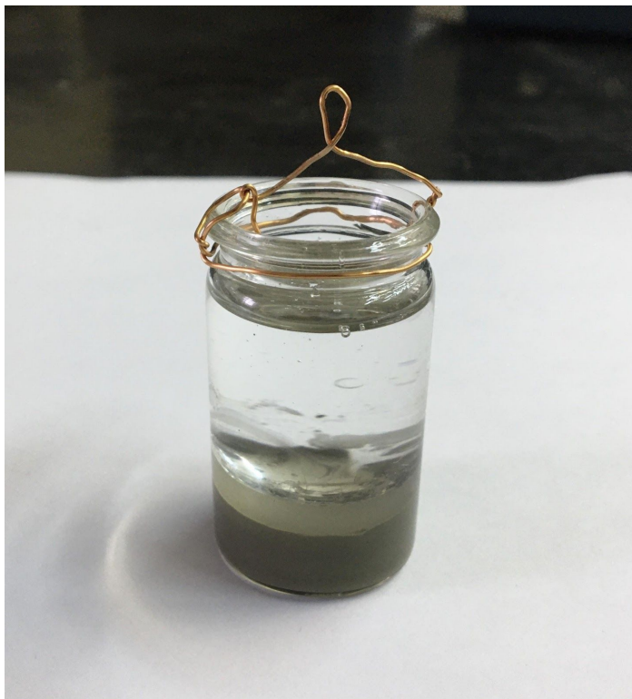
Slika 16. Uzorak cementne paste u bočici neposredno prije početka mjerenja u većoj bočici ispunjenoj parafinom
