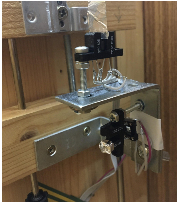
Slika 14. Sustav s pomičnim mehanizmom s dva TCST 2103 senzora. Iznad gornjeg senzora vidljiva je aluminijska zastavica.
