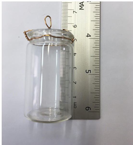
Slika 15. Staklena bočica – nosač uzorka za cement i vodu
