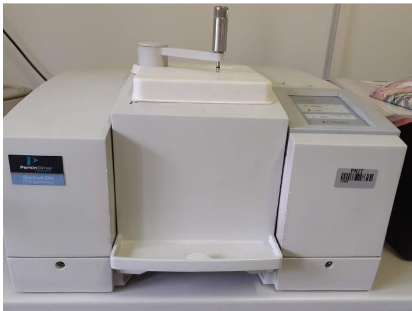
Slika 10. Spektrofotometar s Fourierovom transformacijom signala (Perkin Elmer, SAD).
