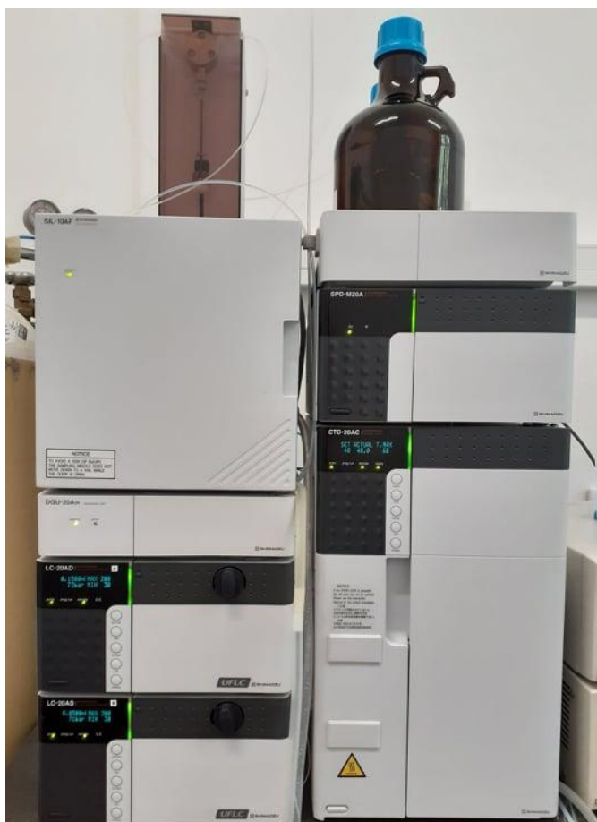
Slika 12. Tekućinski kromatograf HPLC-20 (Shimadzu, Japan).
