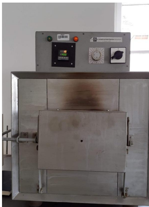
Slika 9. Kalciniranje u mufolnoj peći (Instrumentaria, Hrvatska).
