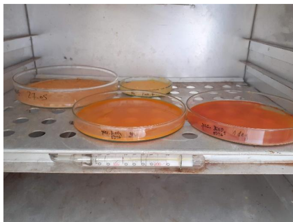
Slika 8. Sušenje BiVO 4 fotokatalizatora sintetiziranih metodom precipitacije.
