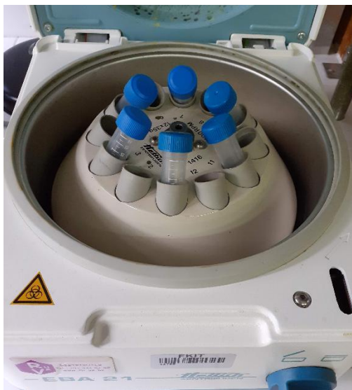
Slika 7. Centrifugiranje katalizatora na centrifugiji EBA 21 (Hettich, Njemačka).
