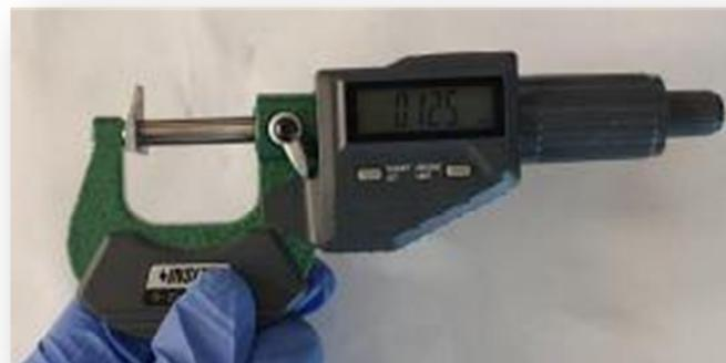
**Slika 3.11.** Mikrometar
