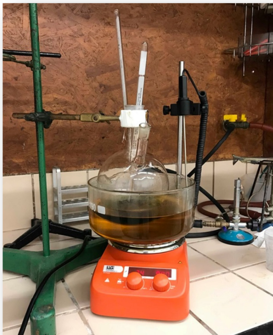
Slika 3.2. Aparatura za sintezu grafena Hummersovom metodom
