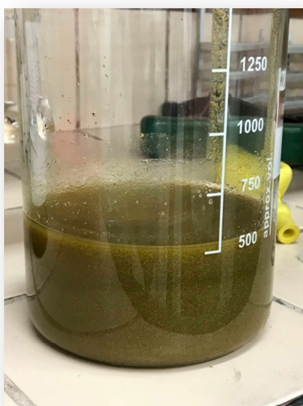
Slika 3.3. Smjesa nakon dodavanja otopine \text{H}_2\text{O}_2
