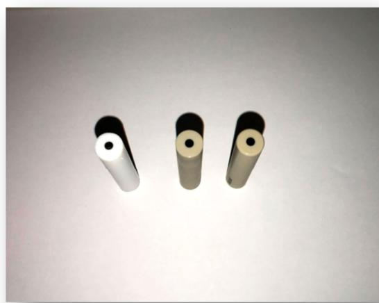
**Slika 3.12.** Disk elektrode od staklastog ugljika
