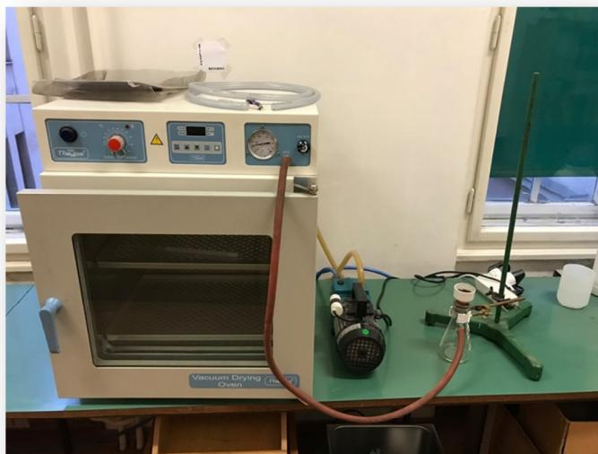
**Slika 3.7.** Aparatura za vakuum filtraciju
