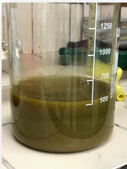
Slika 3.3. Smjesa nakon dodavanja otopine \text{H}_2\text{O}_2
