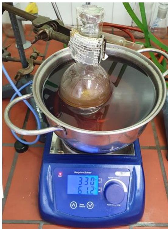
Slika 16. Sinteza biodizela u šaržnom (kotlastom) reaktoru
