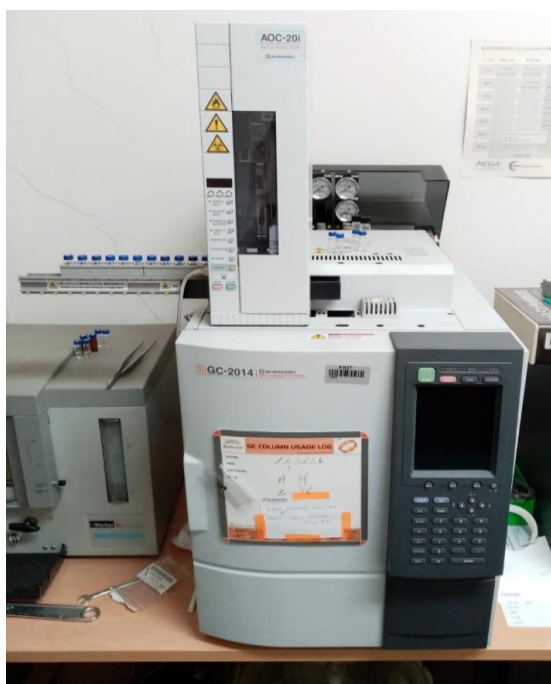
Slika 19. Plinski kromatograf (GC) Shimadzu GC-2014 s FID detektorom
