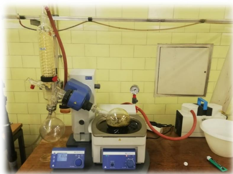
Slika 10. Vakuum isparivač IKA RV 10, rotary evaporator, basic
