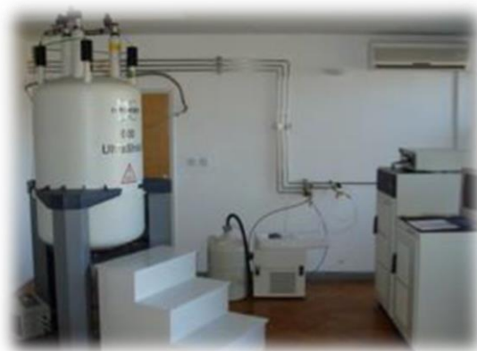
Slika 14. 1 H NMR spektrometar Bruker Avance 300 (CIL, INA d.d.)
