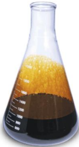
Slika 5. Pirolitičko ulje proizvedeno iz plastičnog otpada 30
