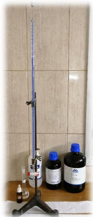
Slika 11. Aparatura za titraciju (bireta)
