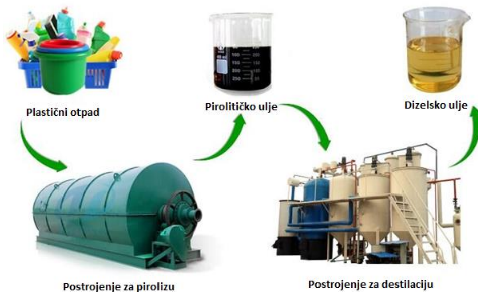
Slika 9. Proces proizvodnje dizelskog ulja iz otpadne plastike 45
