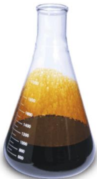
Slika 5. Pirolitičko ulje proizvedeno iz plastičnog otpada 30
