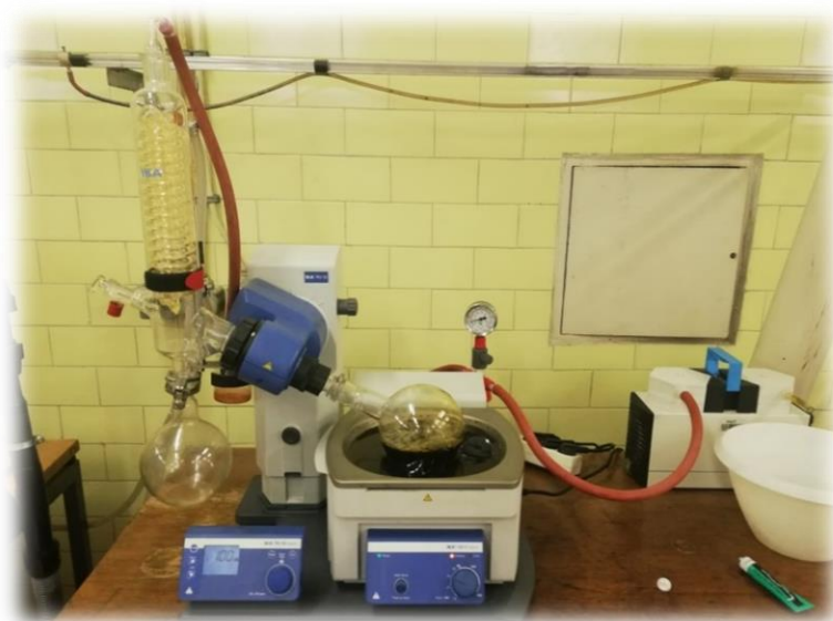
Slika 10. Vakuum isparivač IKA RV 10, rotary evaporator, basic
