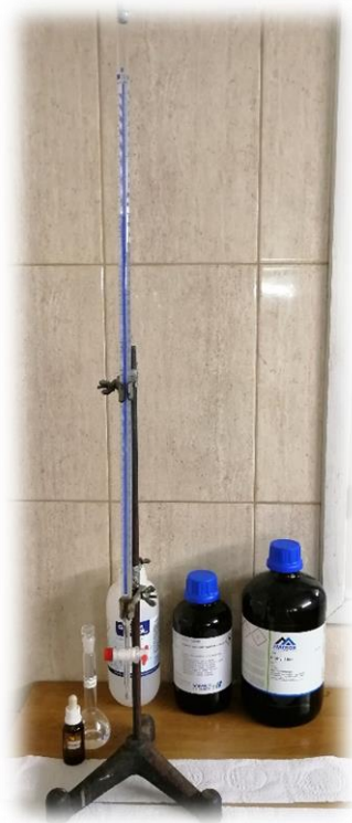
Slika 11. Aparatura za titraciju (bireta)
