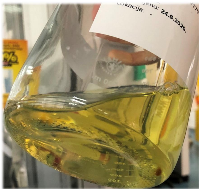
Slika 19. Mješavina dizelskog goriva i pirolitičkog ulja iz plastike u omjeru 90/10 – prikaz taloga
