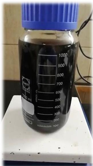
Slika 12. Ekstrakcija pirolitičkog ulja iz plastike
