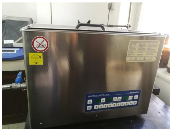
Slika 10. Ultrazvučna kupelj Bandelin Sonorex Digital 10 P
