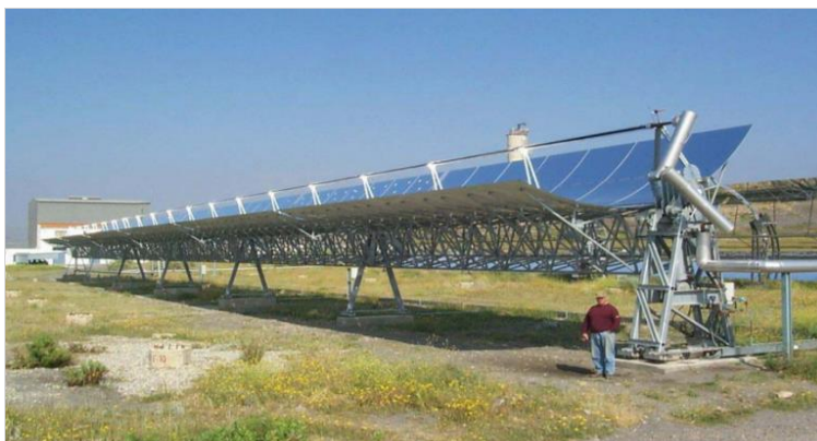
Slika 4. Eurotrough kolektor u solarnoj elektrani Plataforma Solar de Almería [6].
