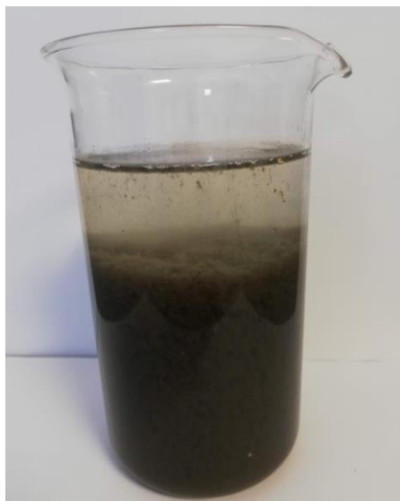
Slika 3.2. Uzorak aktivnog mulja s CUPOVZ.
