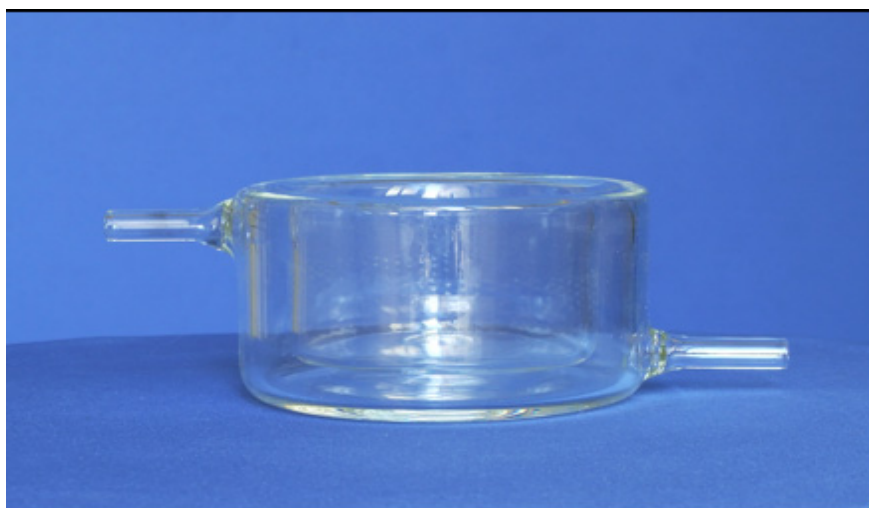
Slika 4. Kotlasti reaktor s vodenim hlađenjem
