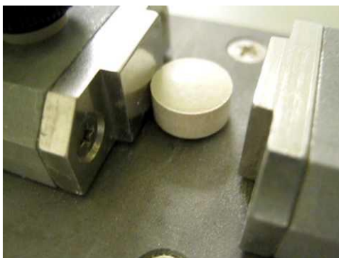
Slika 19. Fotografija uređaja za mjerenje tvrdoće tableta
