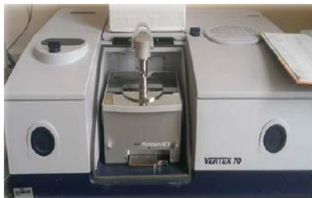
Slika 15. Fotografija FTIR spektrofotometra Vertex 70 s platinastim detektorom (Bruker, Billerica, SAD)
