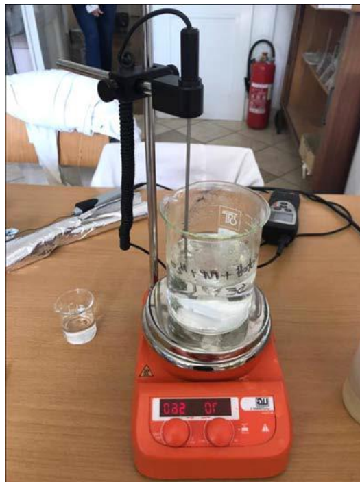
Slika 11. Priprava čvrste disperzije metodom isparavanja otapala
