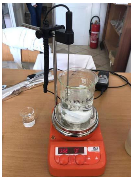
Slika 11. Priprava čvrste disperzije metodom isparavanja otapala
