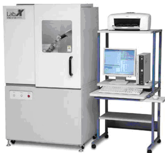
Slika 16. Uređaj za rendgensku difrakciju praha XRD-6300 (Shimadzu, Kyoto, Japan)
