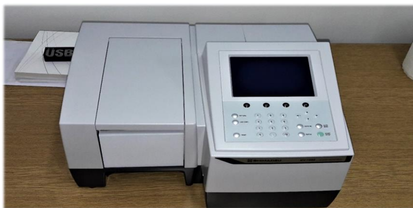
Slika 17. UV/Vis-spektrofotometar Shimadzu UV-1280 (Shimadzu, Kyoto, Japan)
