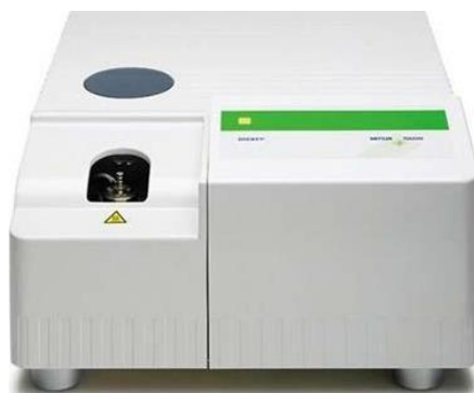
Slika 14. Fotografija diferencijalnog pretražnog kalorimetra Mettler Toledo 822 e (Mettler Toledo GmbH, Greifensee, Švicarska)
