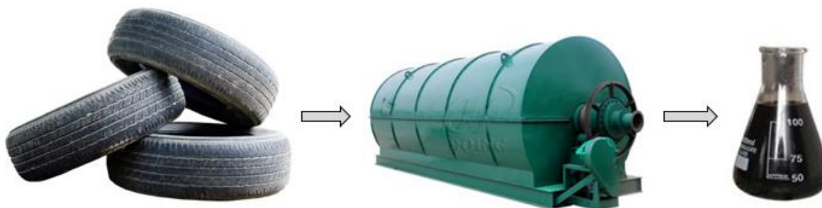
Slika 1. Dobivanje pirolitičkog ulja iz otpadnih guma
