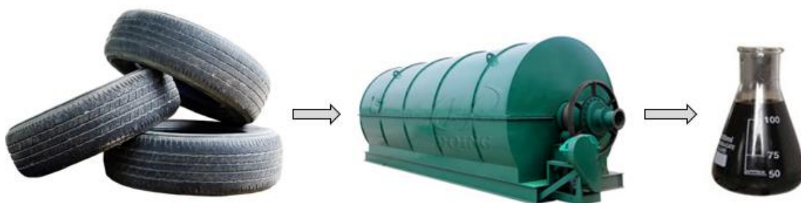
Slika 1. Dobivanje pirolitičkog ulja iz otpadnih guma
