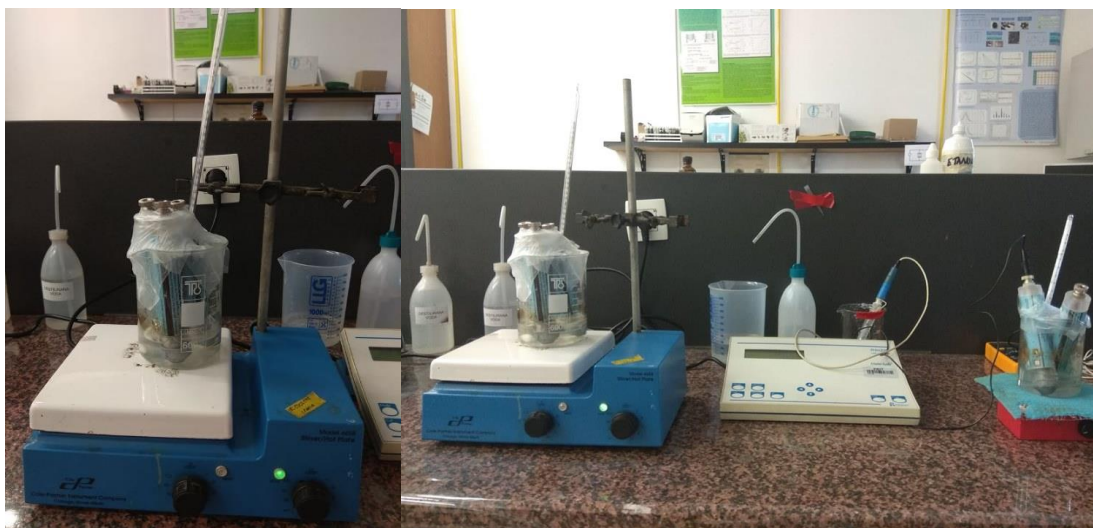
Slika 22. Aparatura za mjerenje korozivnog potencijala cinkovih elektroda
