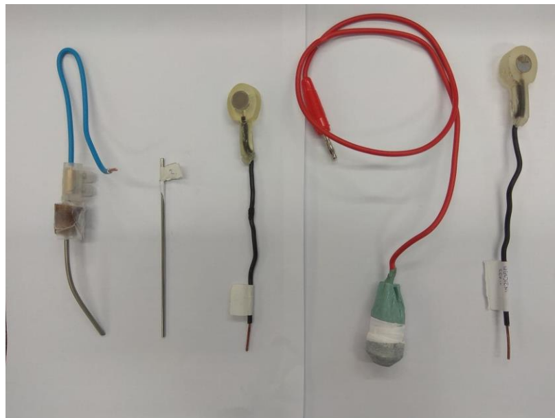
Slika 20. Korištene elektrode s lijeva na desno; titan, legura krom-nikal, legura bakar-nikal, cink, ugljični čelik
