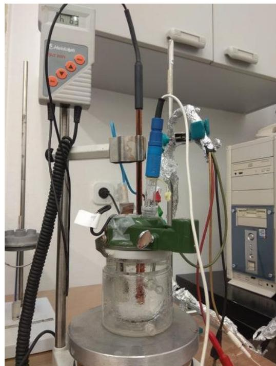
Slika 23. Aparatura za mjerjenje koroziskog potencijala titana i čelika
