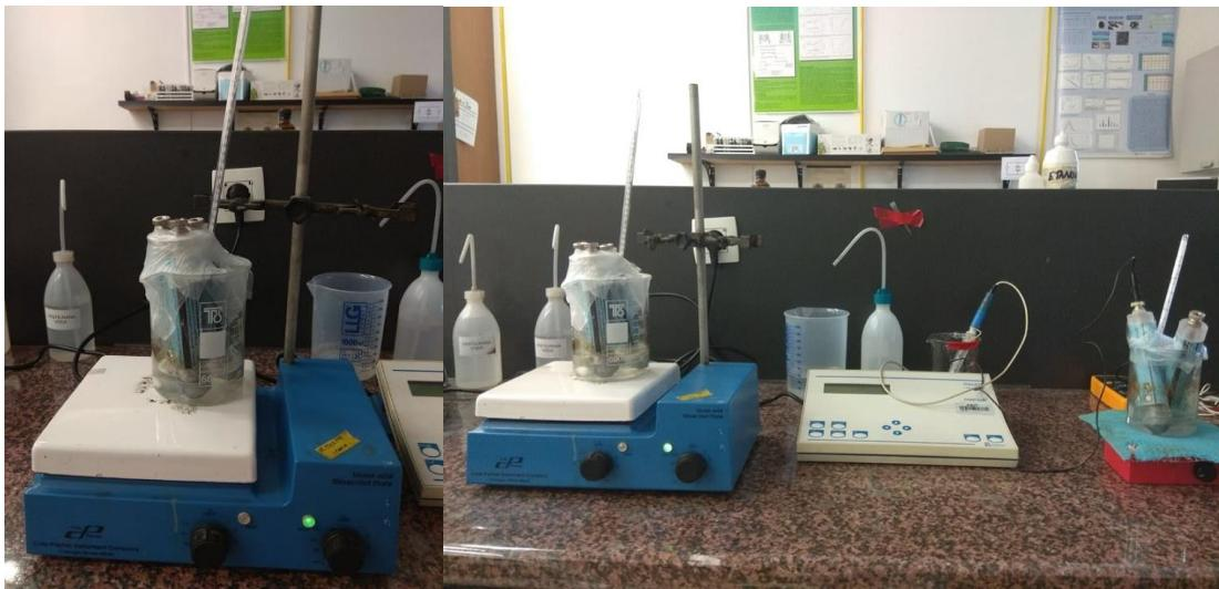
Slika 22. Aparatura za mjerjenje koroziskog potencijala cinkovih elektroda
