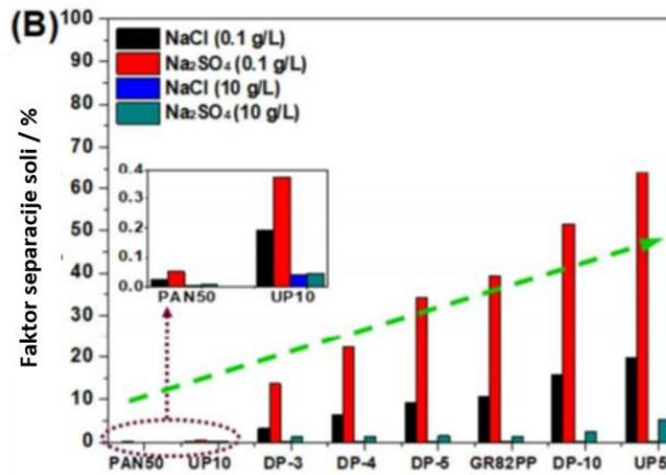
Slika 2.7. Faktor separacije soli ispitivanih UF membrana
