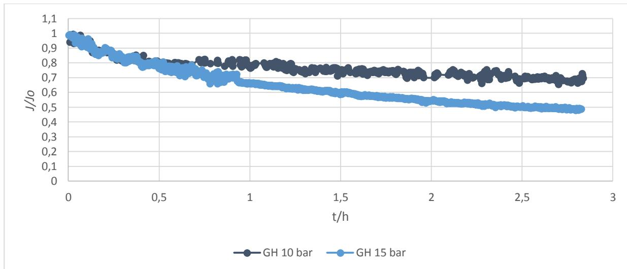
Slika 4.17. Normalizirani fluks GH membrane pri 10 i 15 bar
