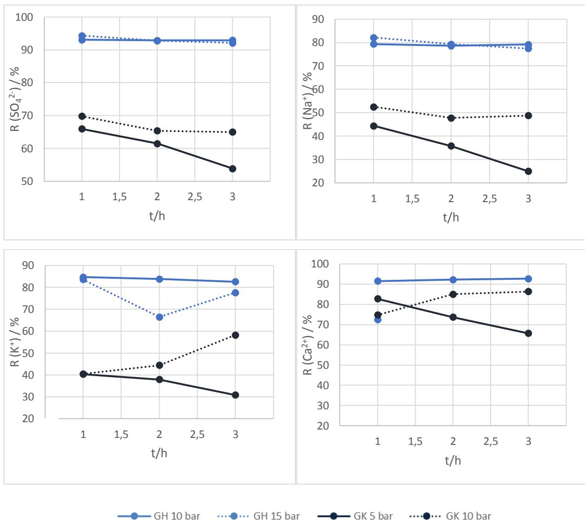
Slika 4.15. Utjecaj promjene radnog tlaka GH (10 i 15 bar) i GK (5 i 10 bar) membrane na smanjenje  $\text{SO}_4^{2-}$ ,  $\text{Ca}^{2+}$ ,  $\text{Na}^+$  i  $\text{K}^+$
