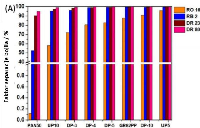
Slika 2.8. Faktor separacije bojila ispitivanih UF membrana
