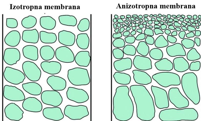
Slika 2.5. Poprečni presjek izotropne i anizotropne membrane
