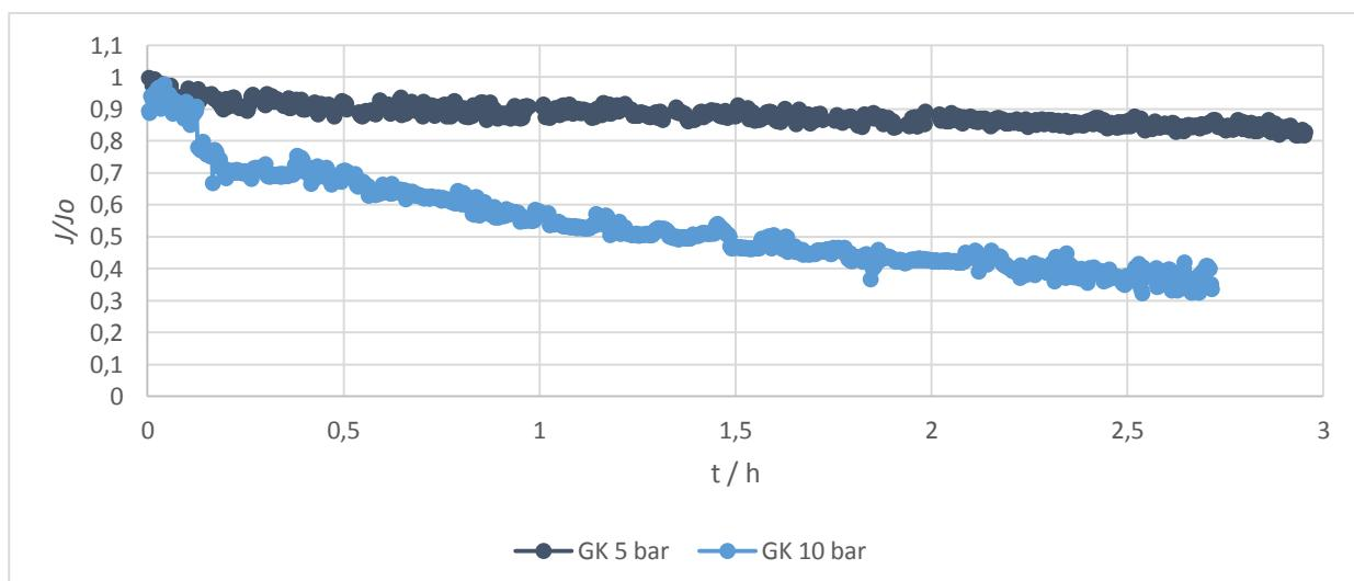
Slika 4.18. Normalizirani fluks GK membrane pri 5 i 10 bar
