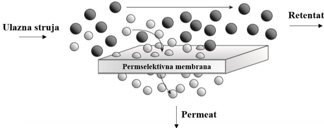
*Slika 2.2. Shematski prikaz membranskog separacijskog procesa<sup>17</sup>*
