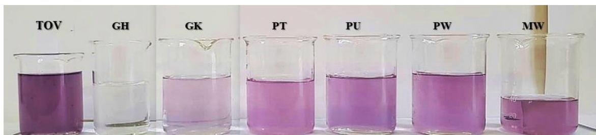
Slika 4.11. Uzorci TOV-a i permeata (3 h) za svaku ispitivanu membranu
