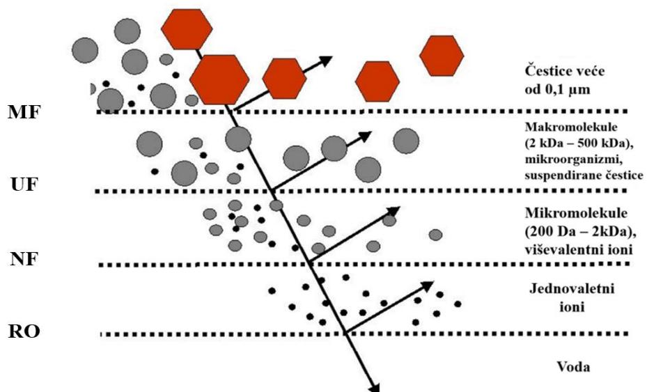
*Slika 2.3. Tlačni membranski procesi*
