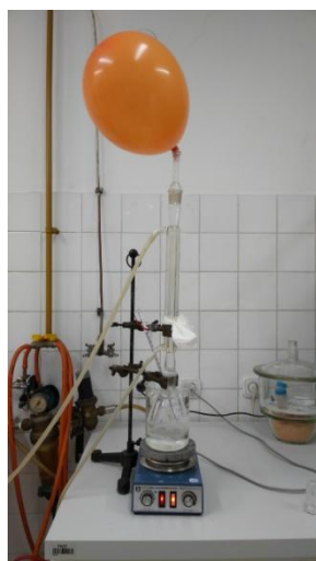
Slika 19. Aparatura za funkcionalizaciju površine mezoporozne silike u inertnoj atmosferi dušika uz refluks
