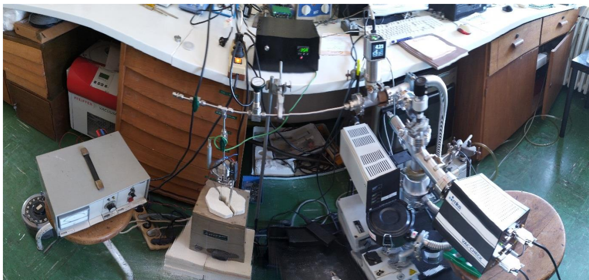
Slika 14. Prikaz TPD-MS instrumenta
