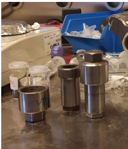
Slika 12. Reakcijska posuda od ojačanog kemijski inertnog čelika
