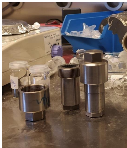
Slika 12. Reakcijska posuda od ojačanog kemijski inertnog čelika
