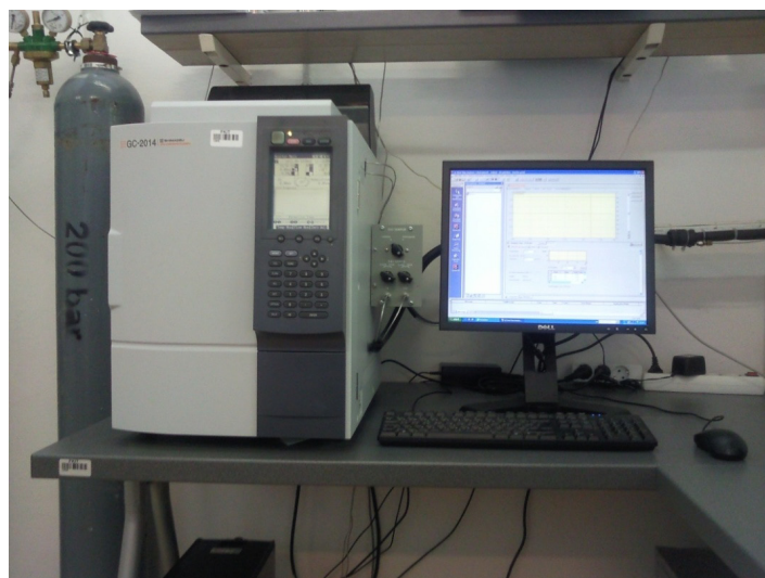
Slika 13. Plinski kromatograf Shimadzu GC 2014
