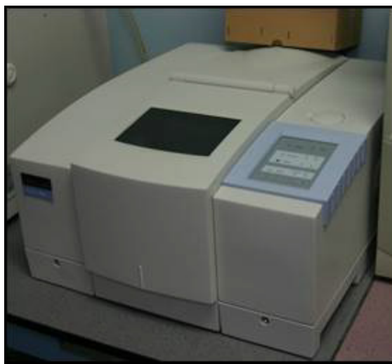
Slika 15. Perkin-Elmer Spectrum One FT-IR spektrometar
