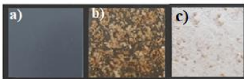
Slika 18. Fotografija čistog LLDPE-a (a), LLDPE/RLJ 50/50 biokompozita (b) i LLDPE/RLJ/TiO 2 50/50/5 biokompozita
