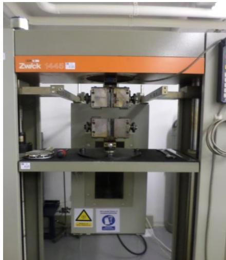
**Slika 23.** Mehanička kidalica
