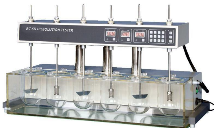
Slika 19. Uređaj za ispitivanje oslobađanja djelatnih tvari (RC-6D, Zhengzhou Nanbei Instrument)
