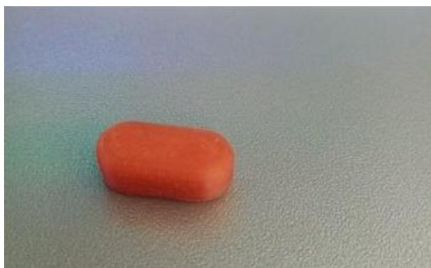
**Slika 8.** 3D tiskana tableta ovalnog oblika
