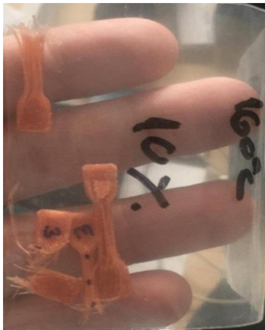
Slika 47. Epruvete nakon ispitivanja na mehaničkoj kidalici
