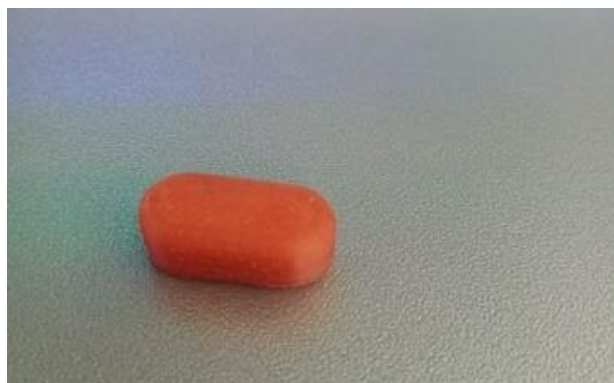
Slika 8. 3D tiskana tableta ovalnog oblika
