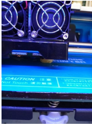
Slika 36. Postupak 3D-tiskanja tablete
